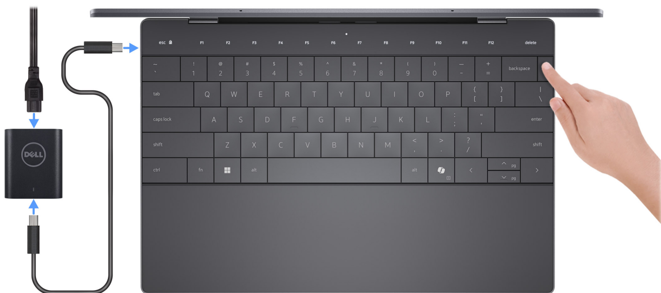
Figur 8. Anslut nätaggregatet och tryck på strömbrytaren.
