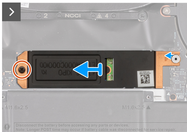
Figur 26. Ta bort M.2 2230 SSD-disken
