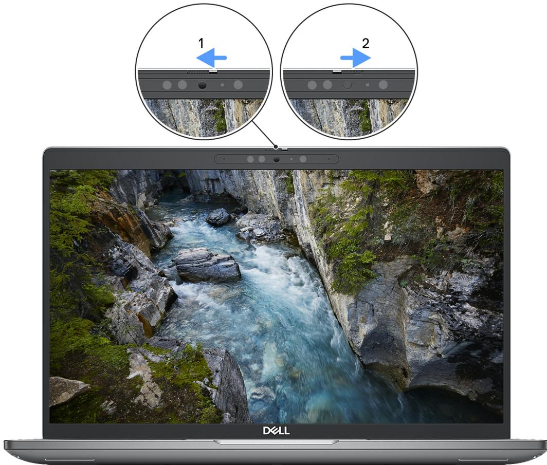
Abbildung 1. Kameraverschluss
