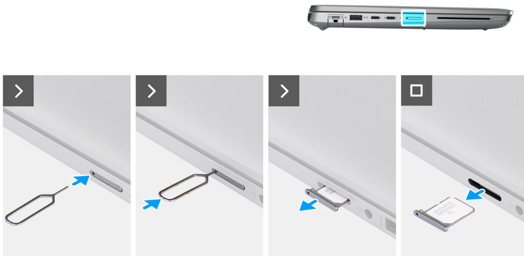
Abbildung 2. Entfernen des SIM-Kartenfachs
