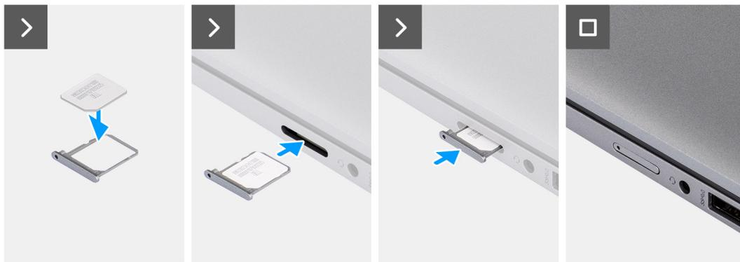
Abbildung 3. Installieren des SIM-Kartenfachs
