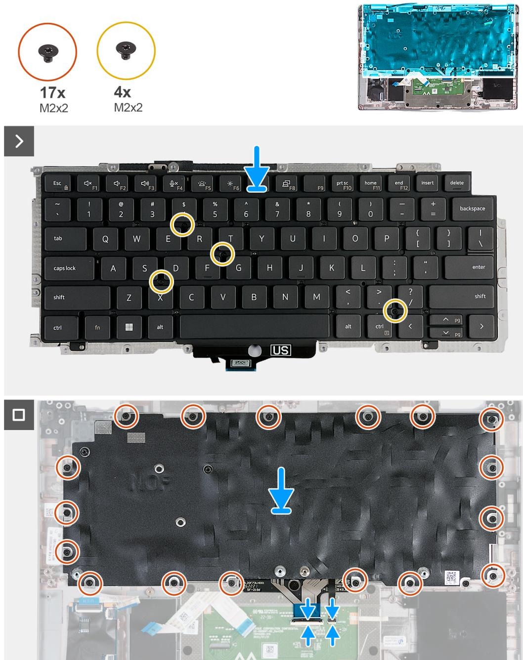
Figure 66. Installation du clavier
