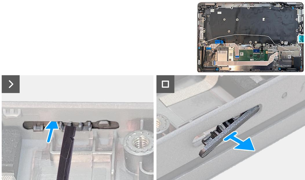
Figure 69. Retrait de la plaque de recouvrement du logement de carte SIM factice
