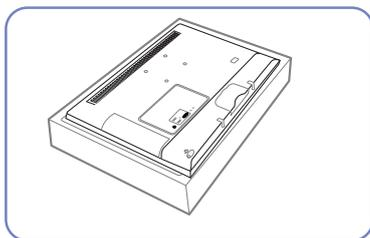
Posez un chiffon doux sur la table, afin de protéger l'appareil. Posez l'appareil sur le chiffon de telle façon que sa partie avant soit tournée vers le bas.
