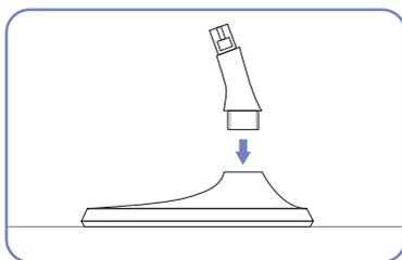
Insérez le connecteur du pied dans le pied, dans le sens indiqué sur l'illustration.
