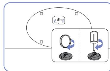
Tournez complètement la vis de connexion dans le bas du pied, de façon à ce qu'il soit solidement fixé.
