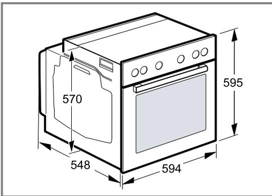
**22.3 Einbau unter einer Arbeitsplatte**
