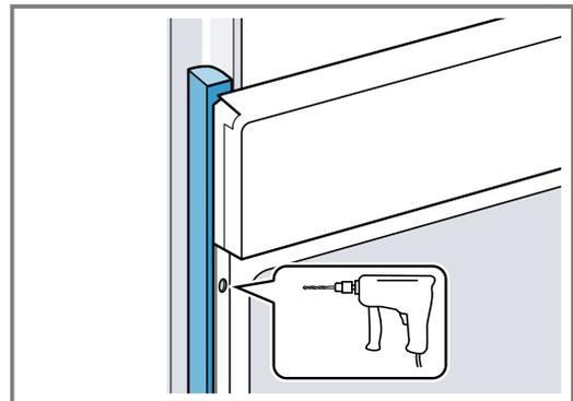
4. Das Gerät mit adäquater Schraube befestigen.
