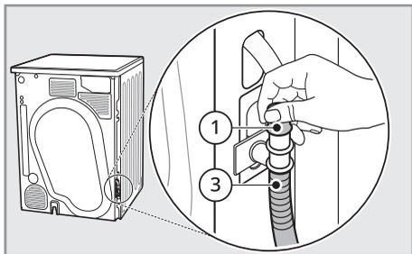
**3** Installieren Sie den Abflussschlauch nach Ihren Installationsgegebenheiten:
