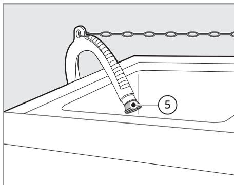
Sichern Sie den Schlauch und die Halterung mit z. B. mit Kabelbindern.
