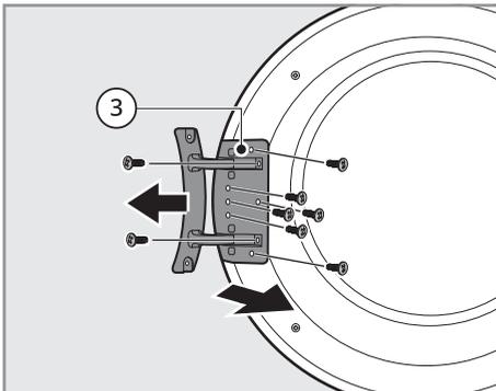
4 Wechseln Sie die Position der Scharnierbaugruppe ③ und der Türverschlussbaugruppe ④ und ziehen Sie die Schrauben in umgekehrter Reihenfolge an.
