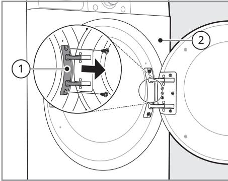
3 Entfernen Sie die 3 Schrauben der Türverschlussbaugruppe ④, die zwischen der Tür und Scharnierbaugruppe angebracht sind, und entfernen Sie dann die Schraube, die am Türhaken angebracht ist.
