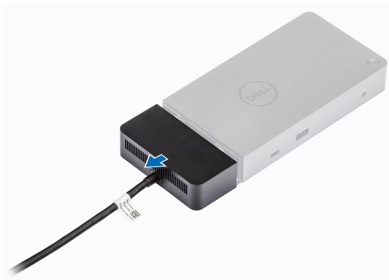
4. Levante y quite el módulo del cable USB de tipo C del conector dentro de la estación de acoplamiento.
