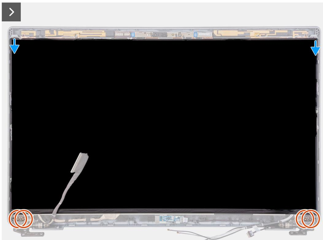
Abbildung 76. Entfernen des Bildschirms
