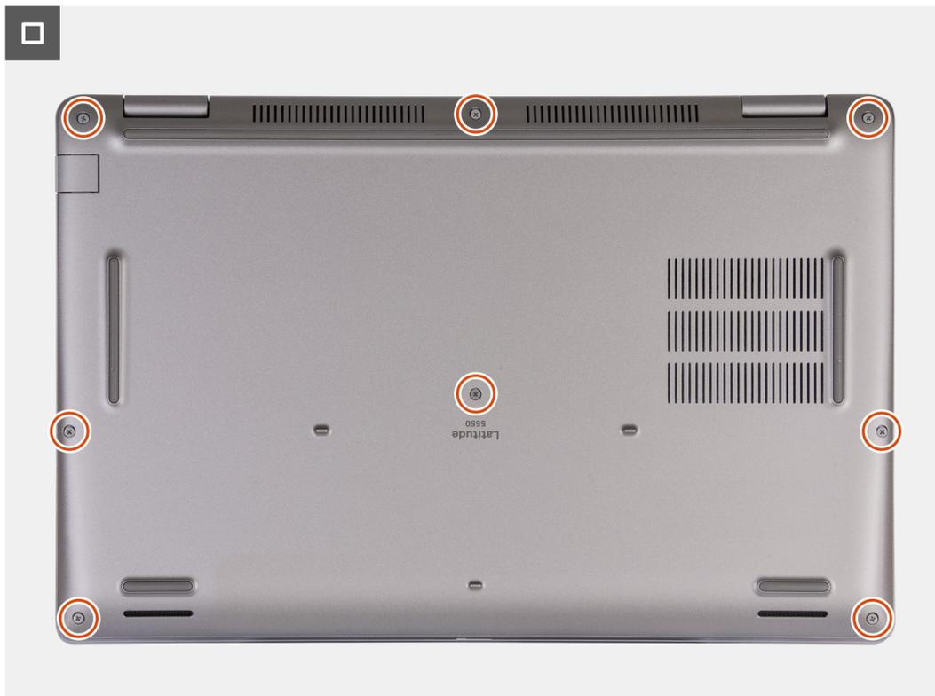
**Abbildung 18. Festziehen der unverlierbaren Schrauben**
