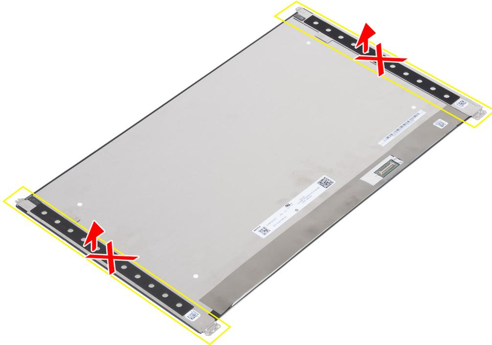
**Abbildung 79. Lösen Sie nicht die SR-Bänder (Stretch Release).**
