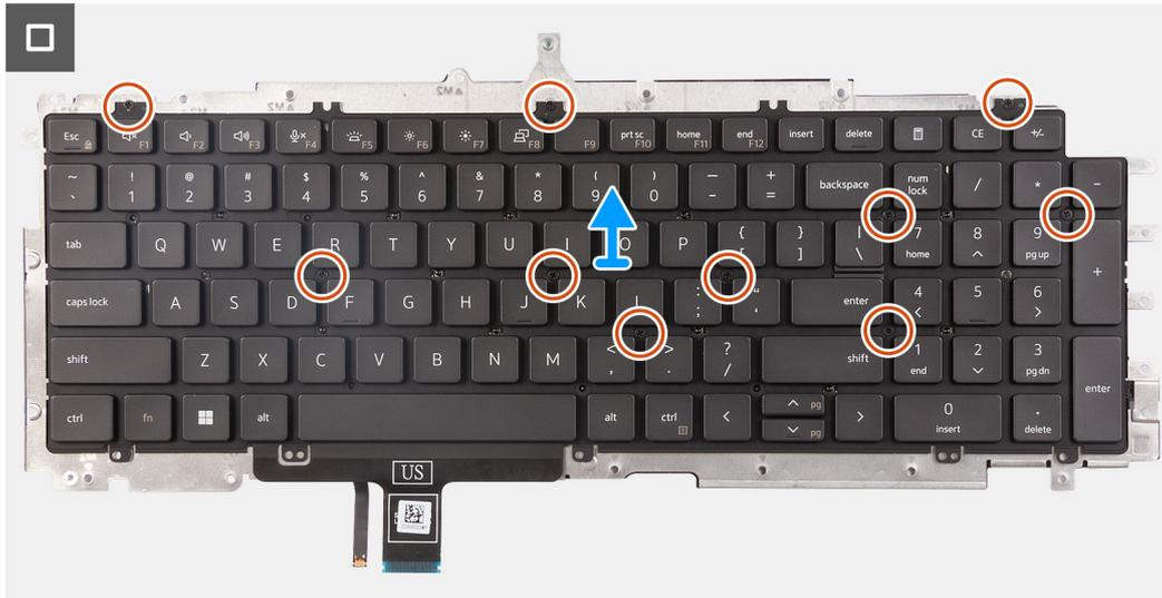
Abbildung 66. Entfernen der Tastatur
