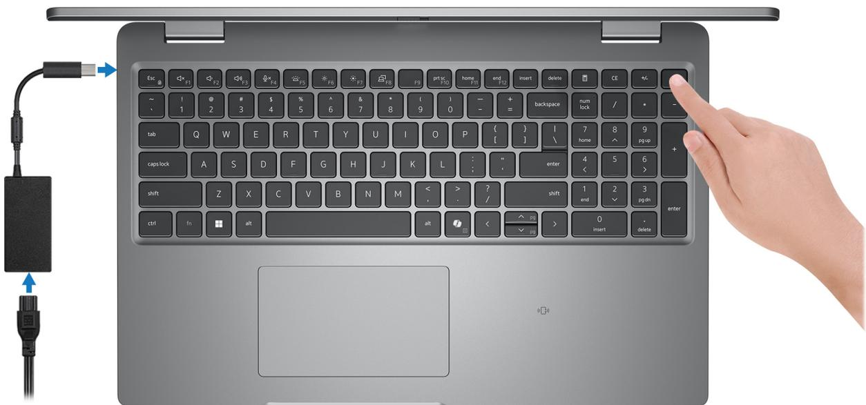
**Abbildung 8. Anschließen des Netzteils und Drücken des Netzschalters**
