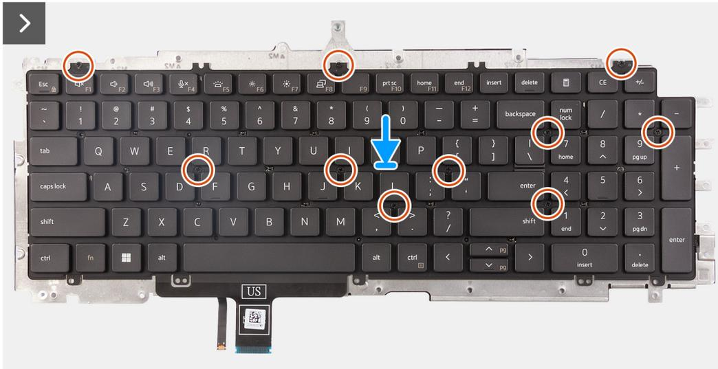
Abbildung 67. Installieren der Tastatur
