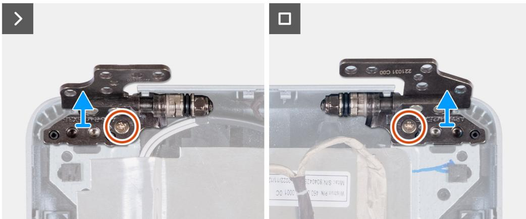
Abbildung 86. Entfernen der Bildschirmscharniere
