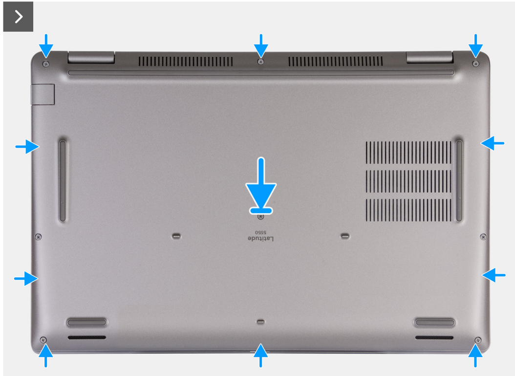
Figure 17. Installation du cache de fond
