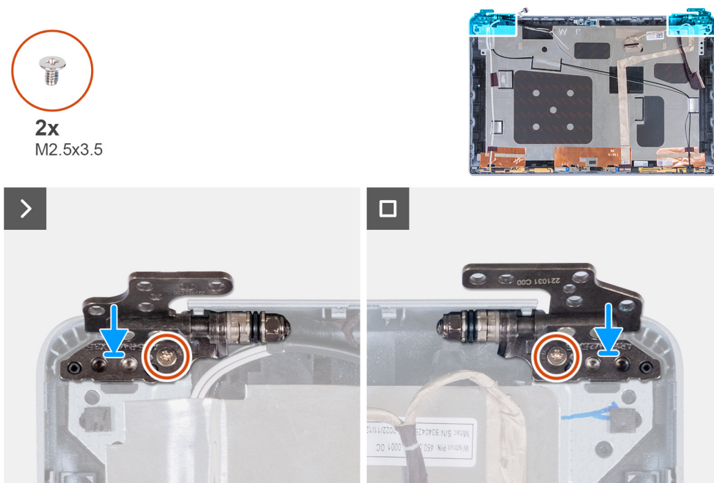
Figure 87. Installation des charnières d'écran
