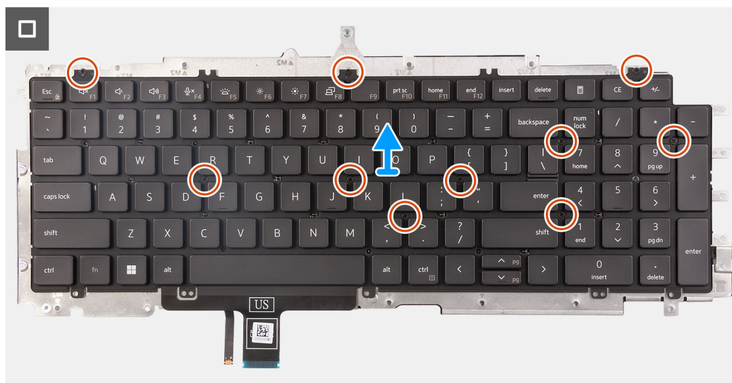
Figure 66. Retrait du clavier
