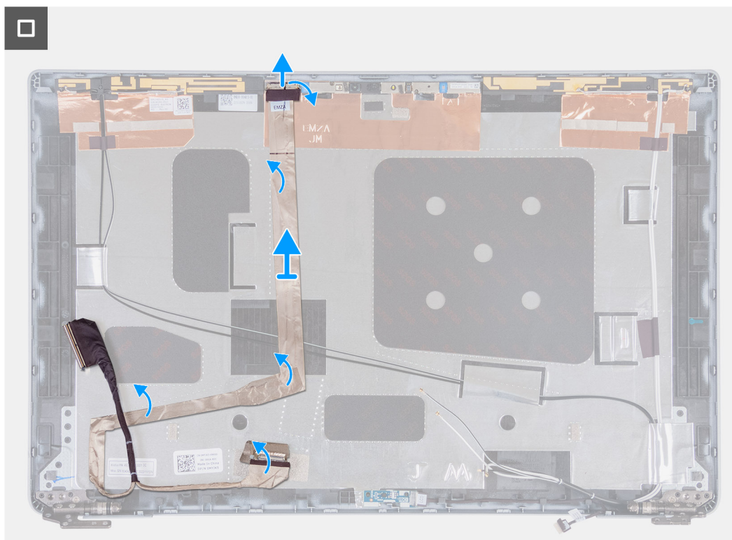
Figure 90. Retrait du câble de l'écran
