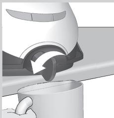
**3** Placez une tasse (d'une contenance d'au moins 350 ml) sous le bouton EASY DE-CALC et tournez-le dans le sens inverse des aiguilles d'une montre.
