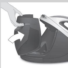
**3** Enfoncez la partie supérieure du réservoir d'eau jusqu'à ce qu'il s'enclenche (« clic »).
