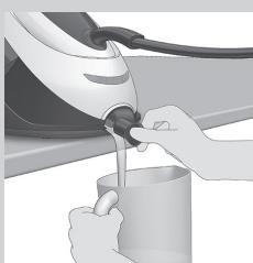
**4** Enlevez le bouton EASY DE-CALC et laissez l'eau avec des dépôts de calcaire s'écouler dans la tasse.
