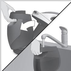
Llene el depósito de agua antes de cada uso o cuando parpadee el piloto “depósito de agua vacío”. Puede llenar el depósito de agua en cualquier momento durante el uso.
