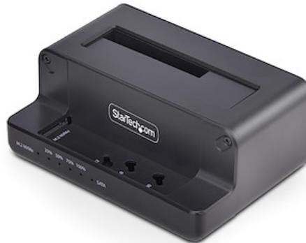
Effectuez un clonage bidirectionnel entre des SSD/HDD SATA 2,5/3,5 pouces et des M.2 NVMe sans ordinateur grâce à ce duplicateur de disque M.2 NVMe vers SATA. La duplication autonome secteur par secteur prend en charge le SATA III (6 Gbps) et fonctionne avec n'importe quel format de fichier.
