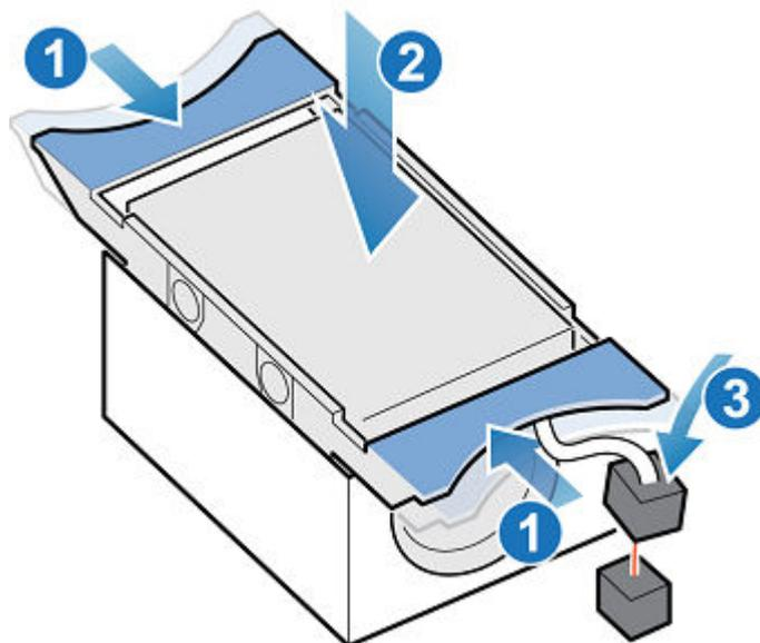
Figure 75. Installing the fan module
