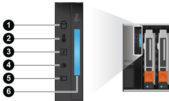
**Abbildung 12. Vorderansicht des NVMe-Erweiterungsgehäuses mit den Status-LEDs**
