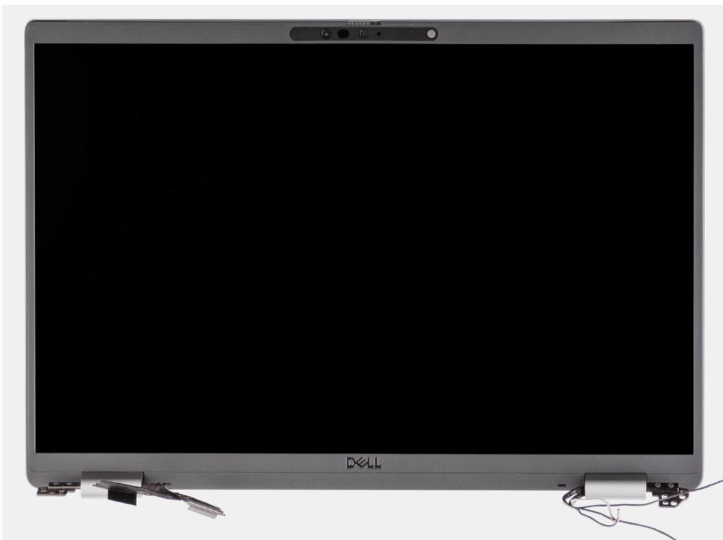
Figure 2. Assemblage d'écran avec câbles d'antenne WWAN
