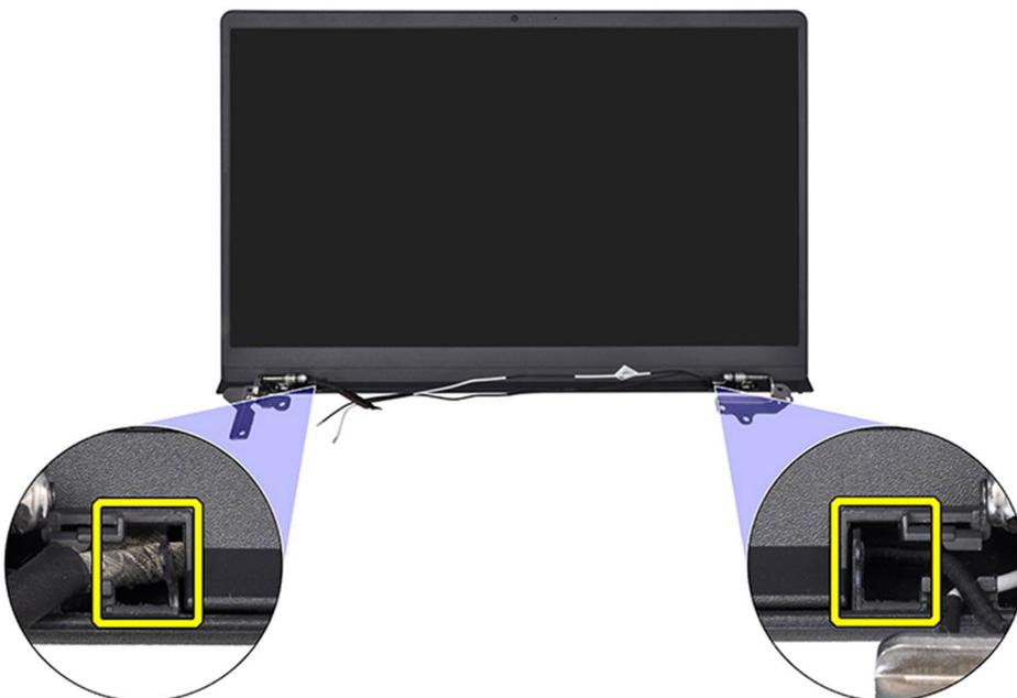
2. Hebeln Sie die Bildschirmblende von der Innenkante an der oberen Seite der Bildschirmbaugruppe ab.
