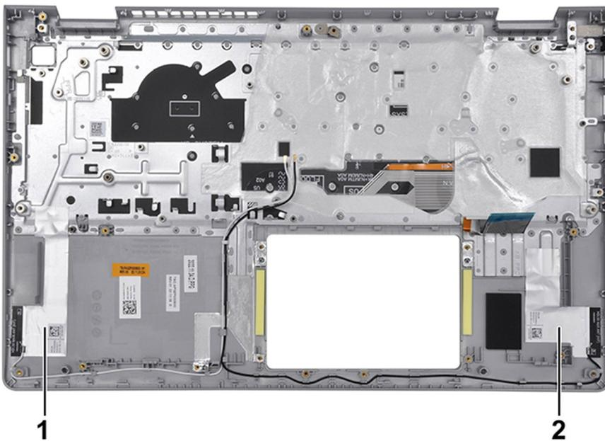
**Tabelle 29. Position der WLAN-Antenne (Haupt- und Zusatzantenne)**
