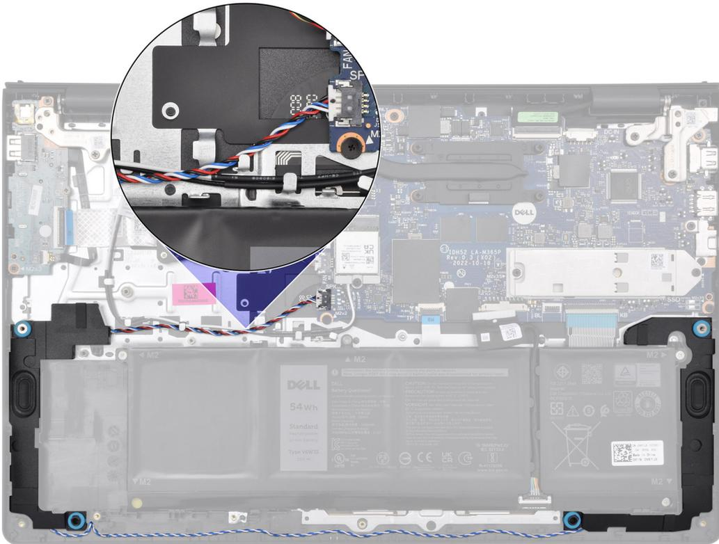
3. Verbinden Sie das Lautsprecherkabel mit der Systemplatine.
