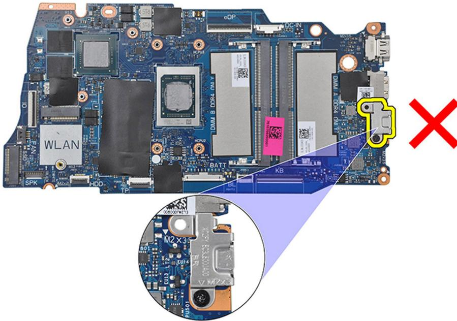
7. Heben Sie die Systemplatine sorgfältig aus dem Gehäuse heraus.
