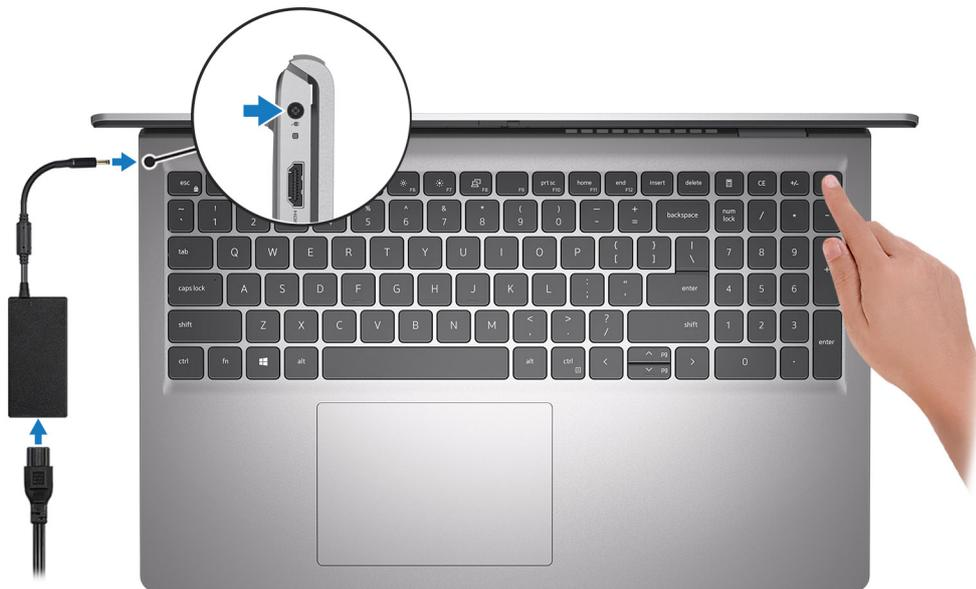
**ANMERKUNG:** Um Energie zu sparen, wechselt der Akku möglicherweise in den Energiesparmodus. Schließen Sie den Netzadapter an und drücken Sie den Betriebsschalter, um den Computer einzuschalten.
