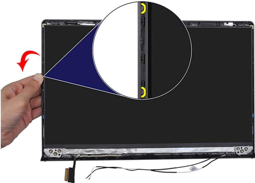
4. Heben Sie die Unterseite des Bildschirms an und schieben Sie sie nach unten, um die Bildschirmhalterungen aus den Schlitzen an der Oberseite der Bildschirmabdeckung zu lösen.
