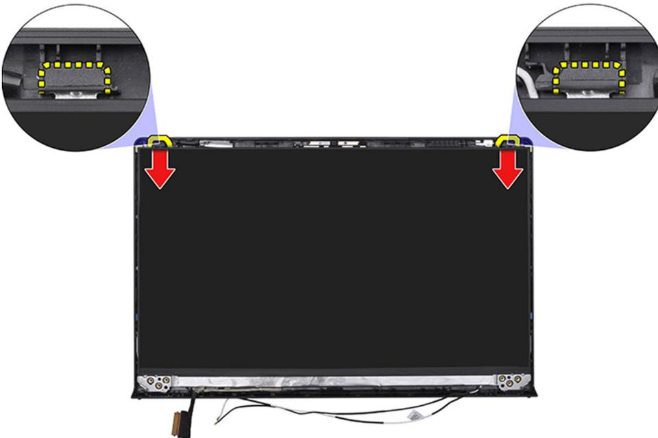
5. Drehen Sie die Bildschirmbaugruppe vorsichtig nach vorne und ziehen Sie das Mylar-Klebeband ab, mit dem das Bildschirmkabel an der Rückseite des Bildschirms befestigt ist.
