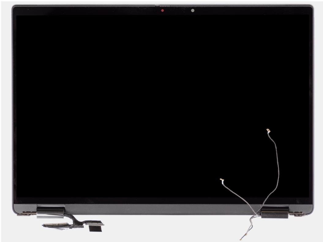
**Ilustración 1. Ensamblaje de la pantalla con cables de la antena WWAN**
