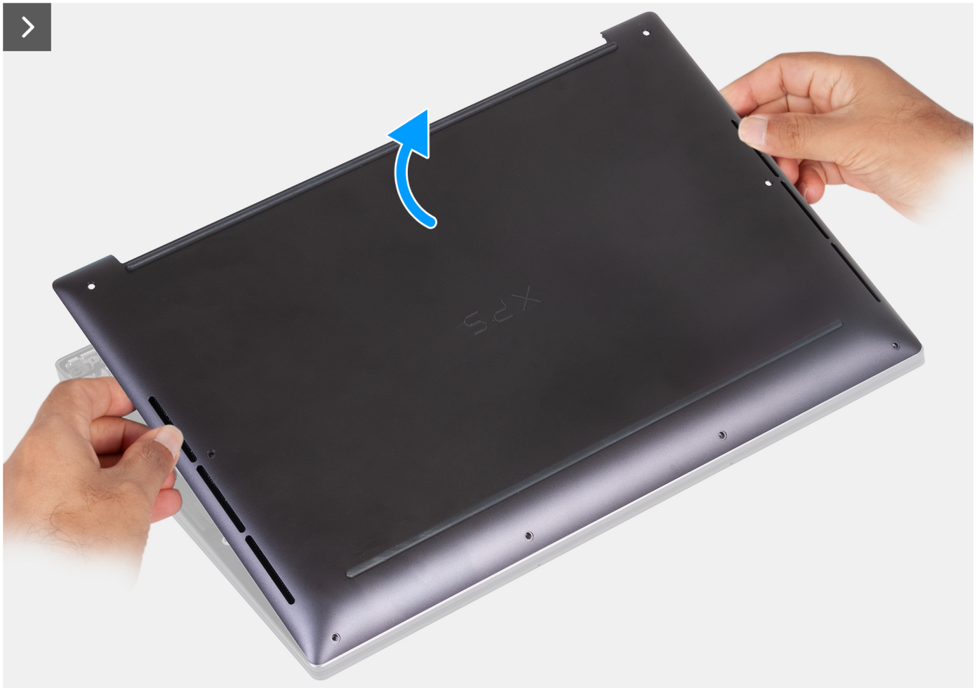
Afbeelding 11. Til de onderplaat van de palmsteuneenheid
