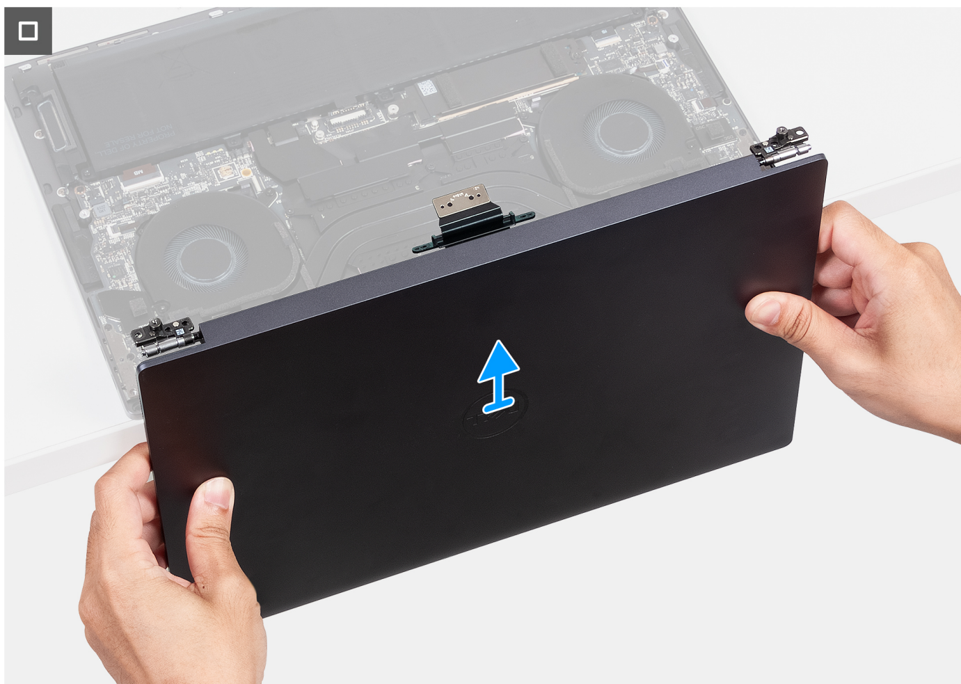
Afbeelding 28. De beeldschermeenheid verwijderen
