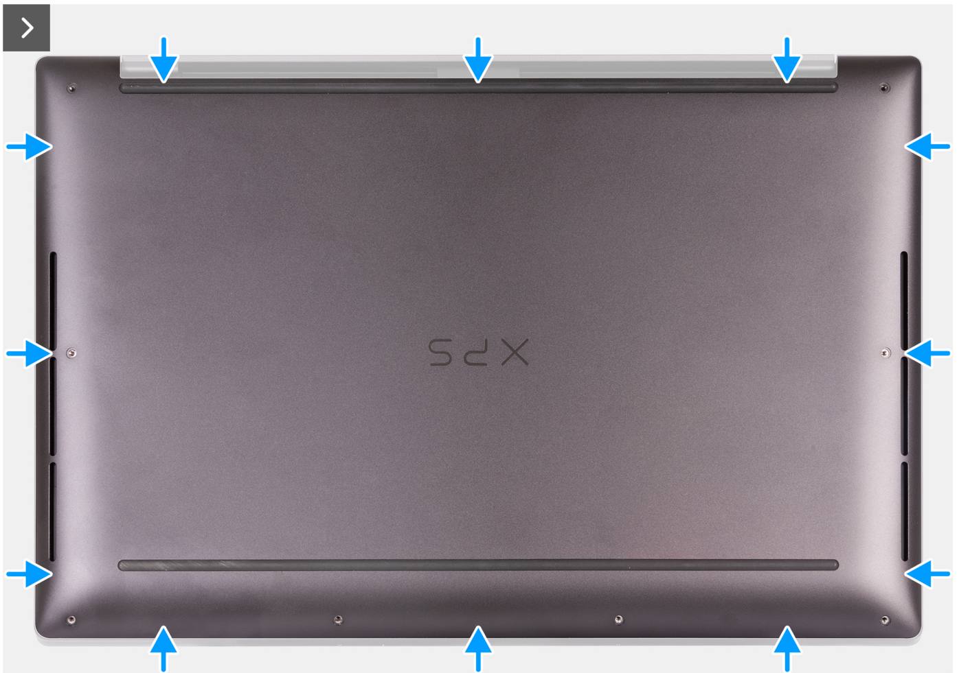
Afbeelding 15. Klik de onderplaat vast op de palmsteuneenheid
