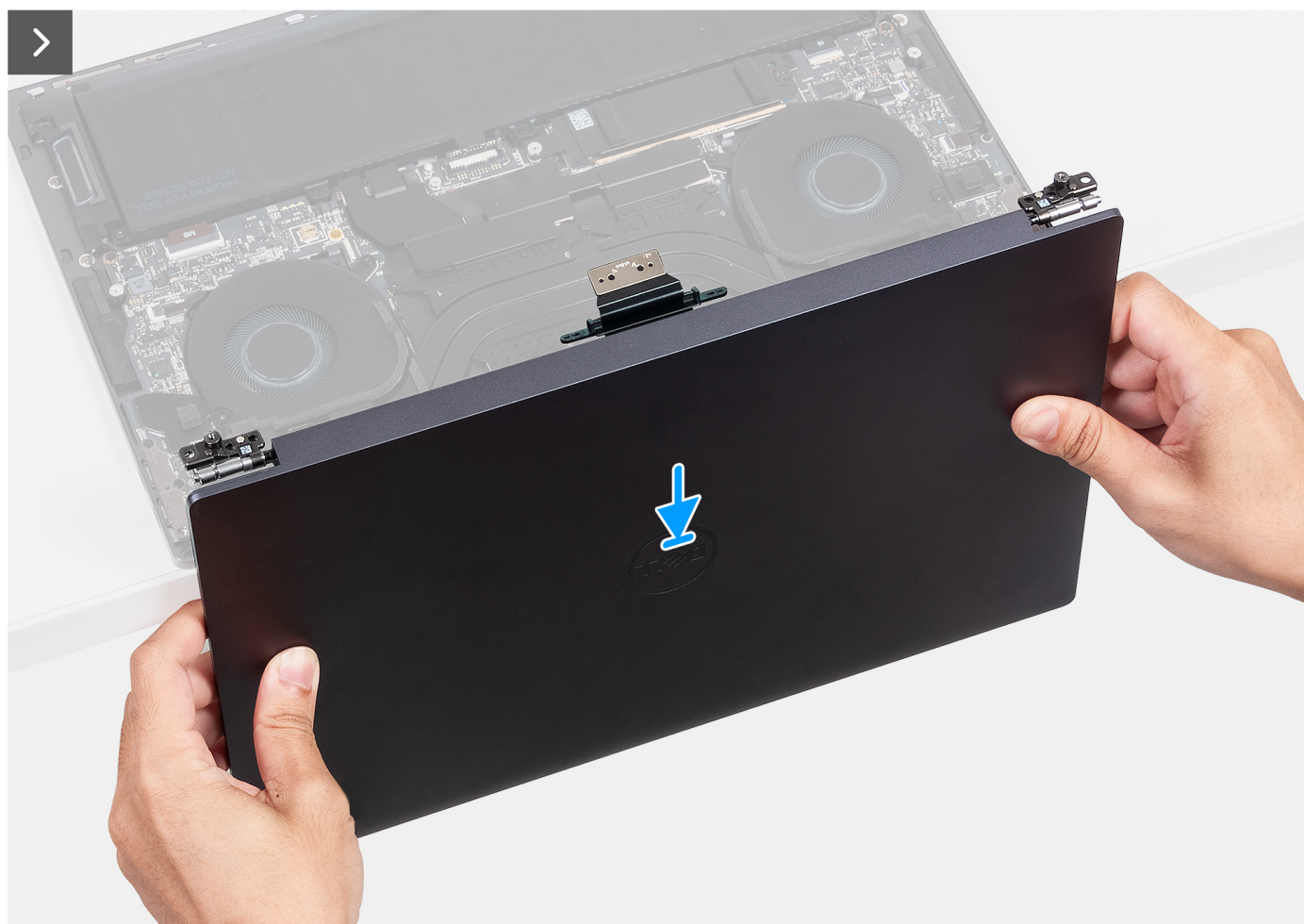
Ilustración 30. Instalación del ensamblaje de la pantalla
