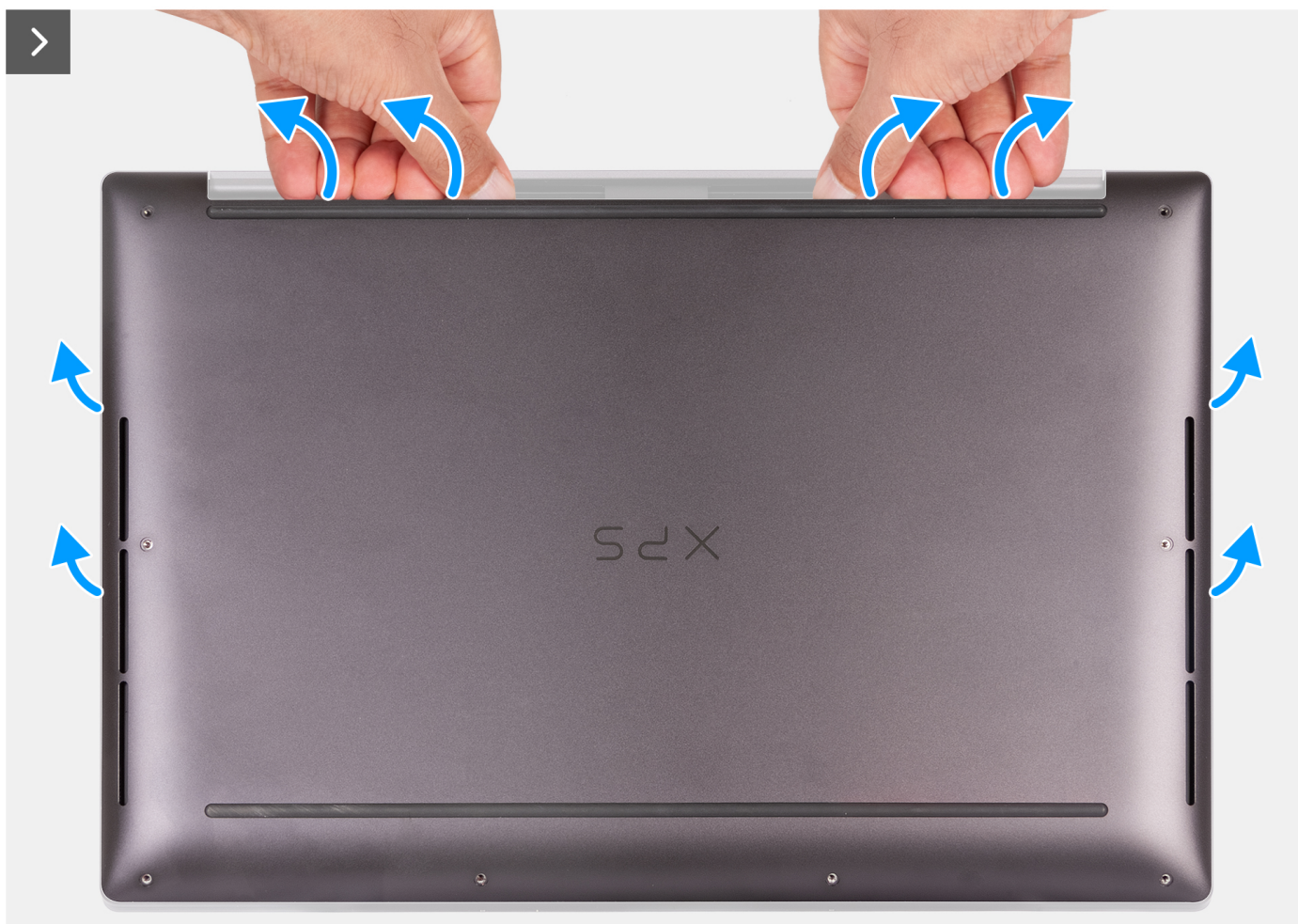
Ilustración 10. Uso de ambos pulgares para hacer palanca en la cubierta de la base
