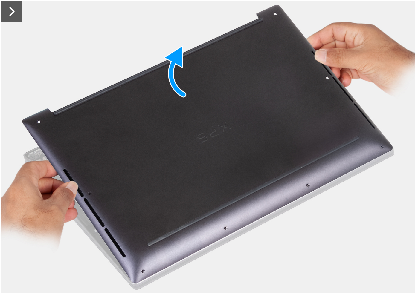
Ilustración 11. Levantamiento de la cubierta de la base para extraerla del ensamblaje del reposamanos
