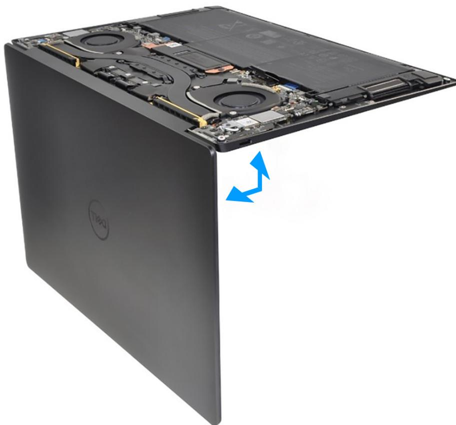
**Ilustración 39. Abra el ensamblaje de la pantalla en un ángulo de 90 grados.**
