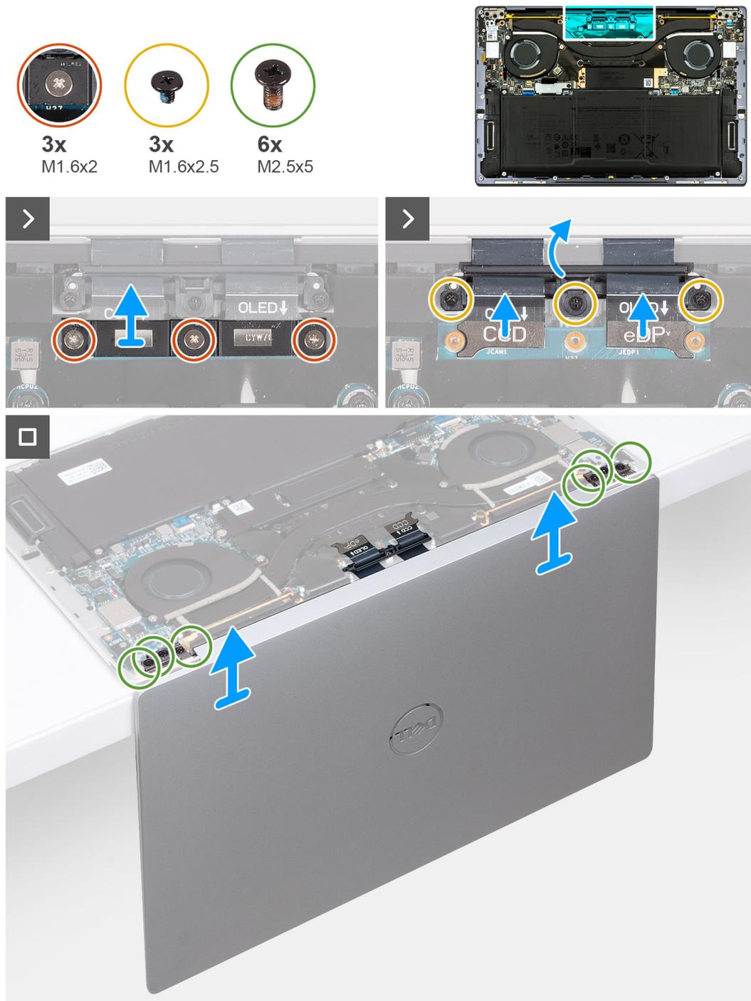
**Ilustración 31. Extracción del ensamblaje de la pantalla**
