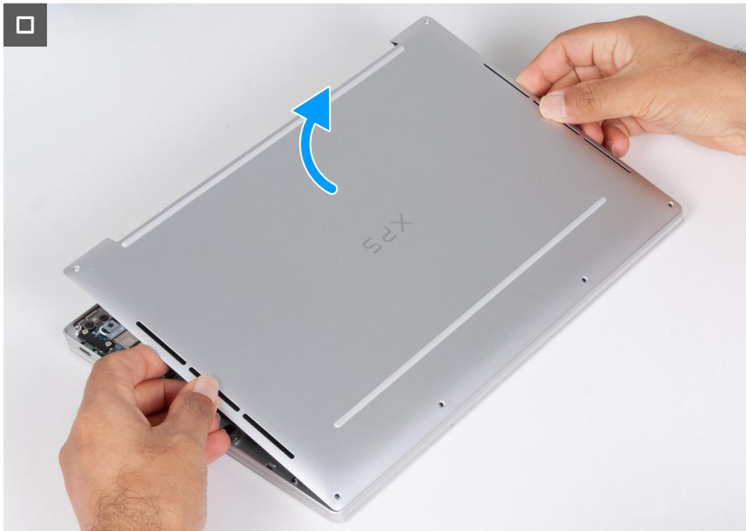
Ilustración 11. Extracción de la cubierta de la base
