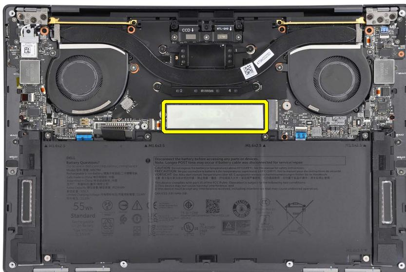
3. Deslice y coloque la SSD M.2 2230 en la almohadilla térmica, en la ranura de SSD.
