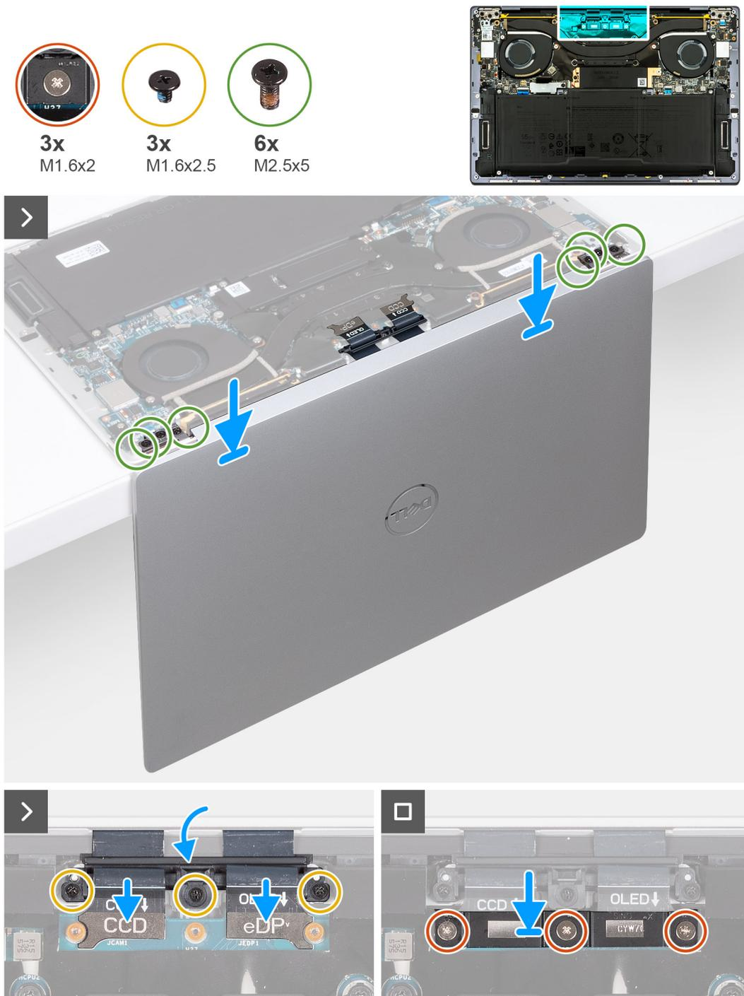
**Ilustración 33. Instalación del ensamblaje de la pantalla**
