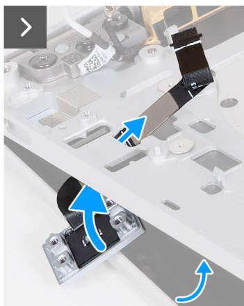
Afbeelding 44. De aan-uitknop met vingerafdrukkezer plaatsen
