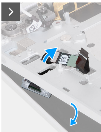
Afbeelding 44. De aan-uitknop met vingerafdrukkezer plaatsen
