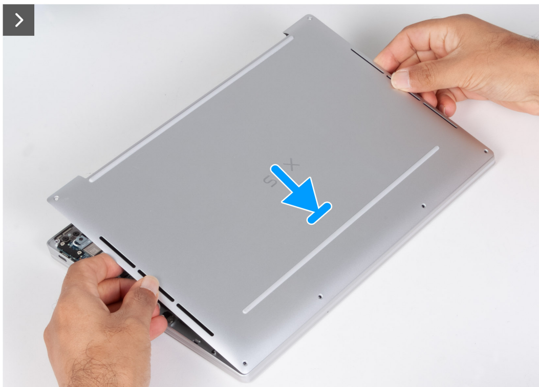
Afbeelding 12. De onderplaat plaatsen
