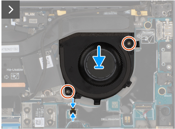
Figure 31. Installing the left fan
