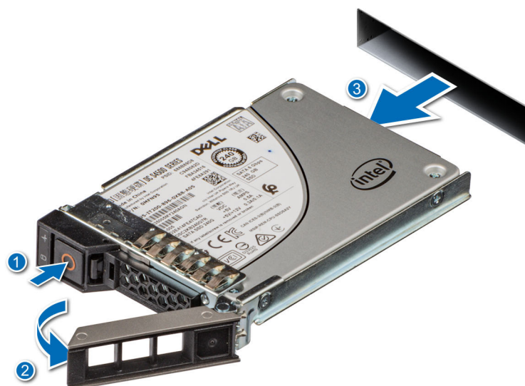
Figure 49. Retrait d'un support de disque
