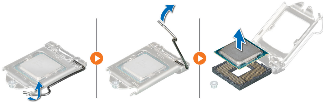
Figure 59. Retrait du processeur
