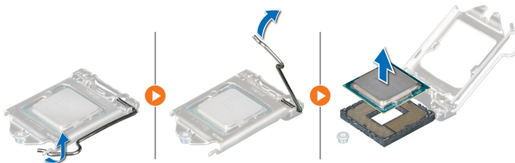
Figure 38. Retrait du processeur
