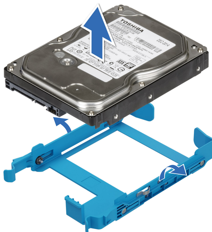
Figure 24. Retrait d'un disque dur installé de son support
