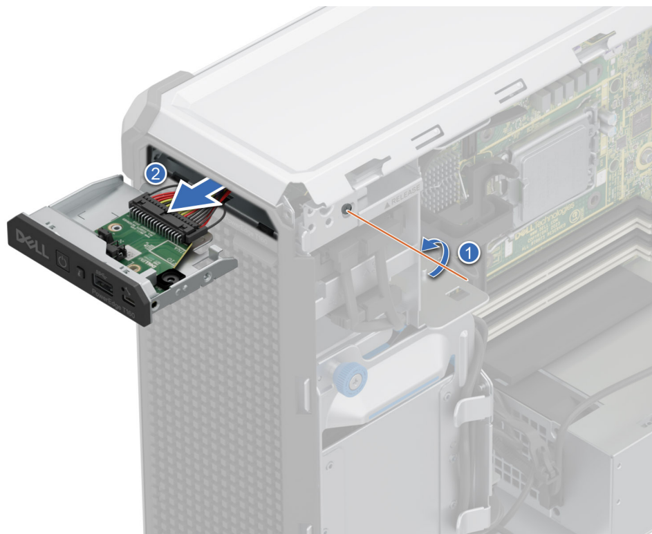
Figure 66. Retrait du bâti du panneau de commandes
