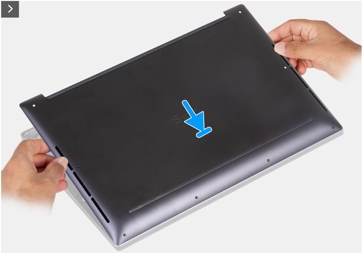
**Abbildung 14. Einsetzen der Bodenabdeckung in die Steckplätze auf der Handauflagenbaugruppe**
