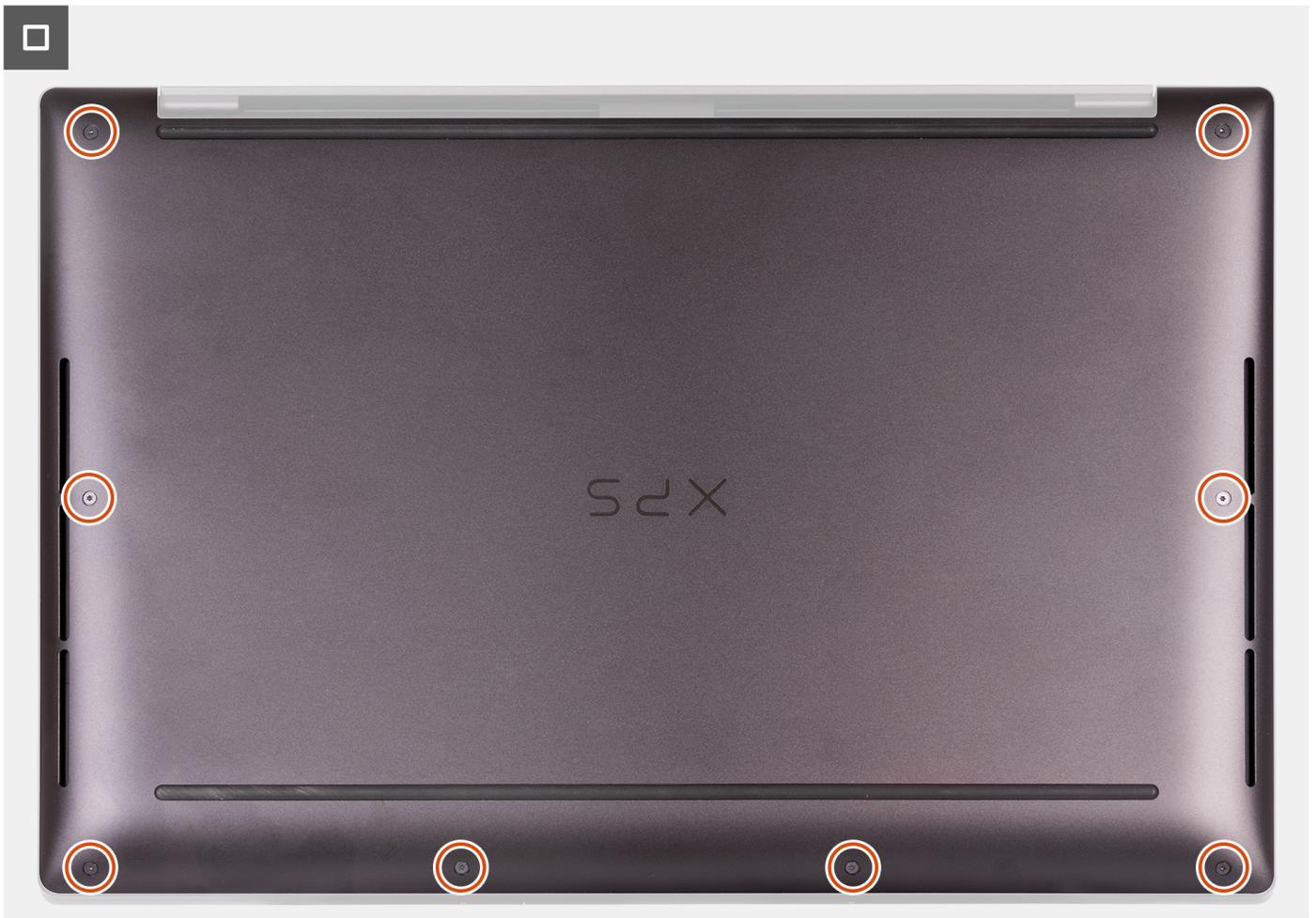
Abbildung 16. Festziehen der acht Schrauben zur Befestigung der Bodenabdeckung an der Handauflagenbaugruppe
