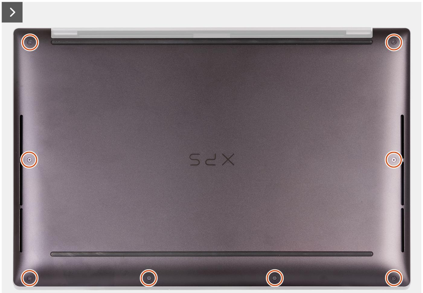
**Abbildung 9. Entfernen der Bodenabdeckung**
