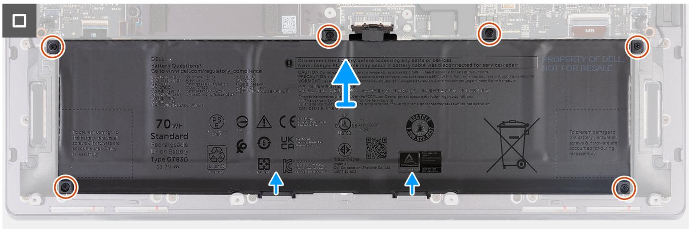
Abbildung 17. Entfernen des Akkus
