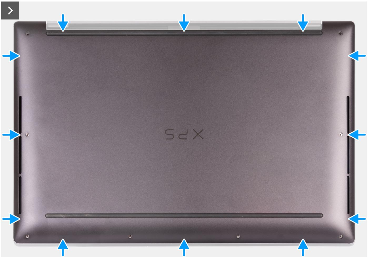
**Abbildung 15. Einrasten der Bodenabdeckung auf der Handauflagenbaugruppe**
