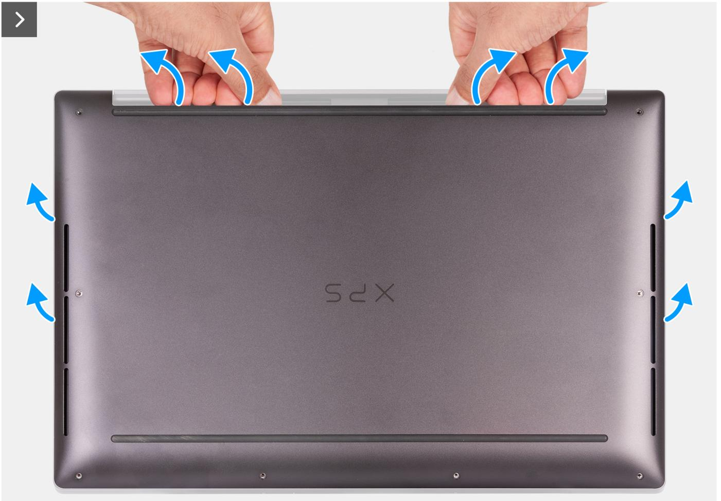
**Abbildung 10. Aufhebeln der Bodenabdeckung mit beiden Daumen**
