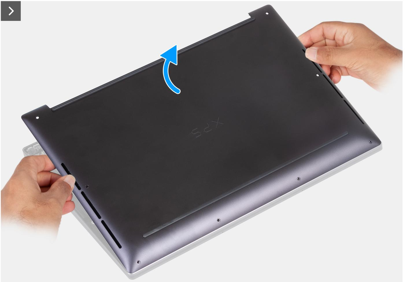
**Abbildung 11. Abheben der Bodenabdeckung von der Handauflagenbaugruppe**
