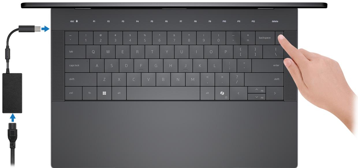
**Abbildung 8. Schließen Sie den Netzadapter an und drücken Sie den Betriebsschalter.**
