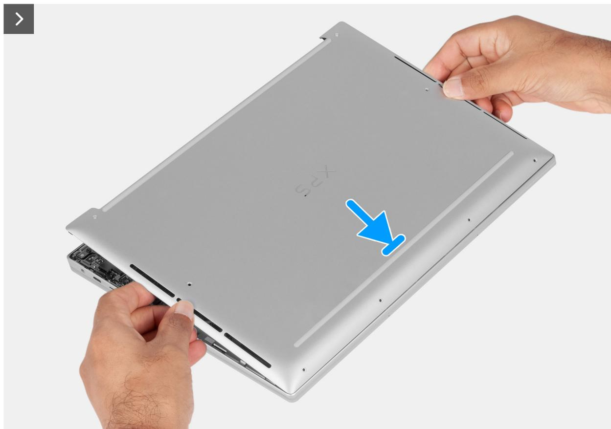
**Figura17. Instalar a tampa da base**
