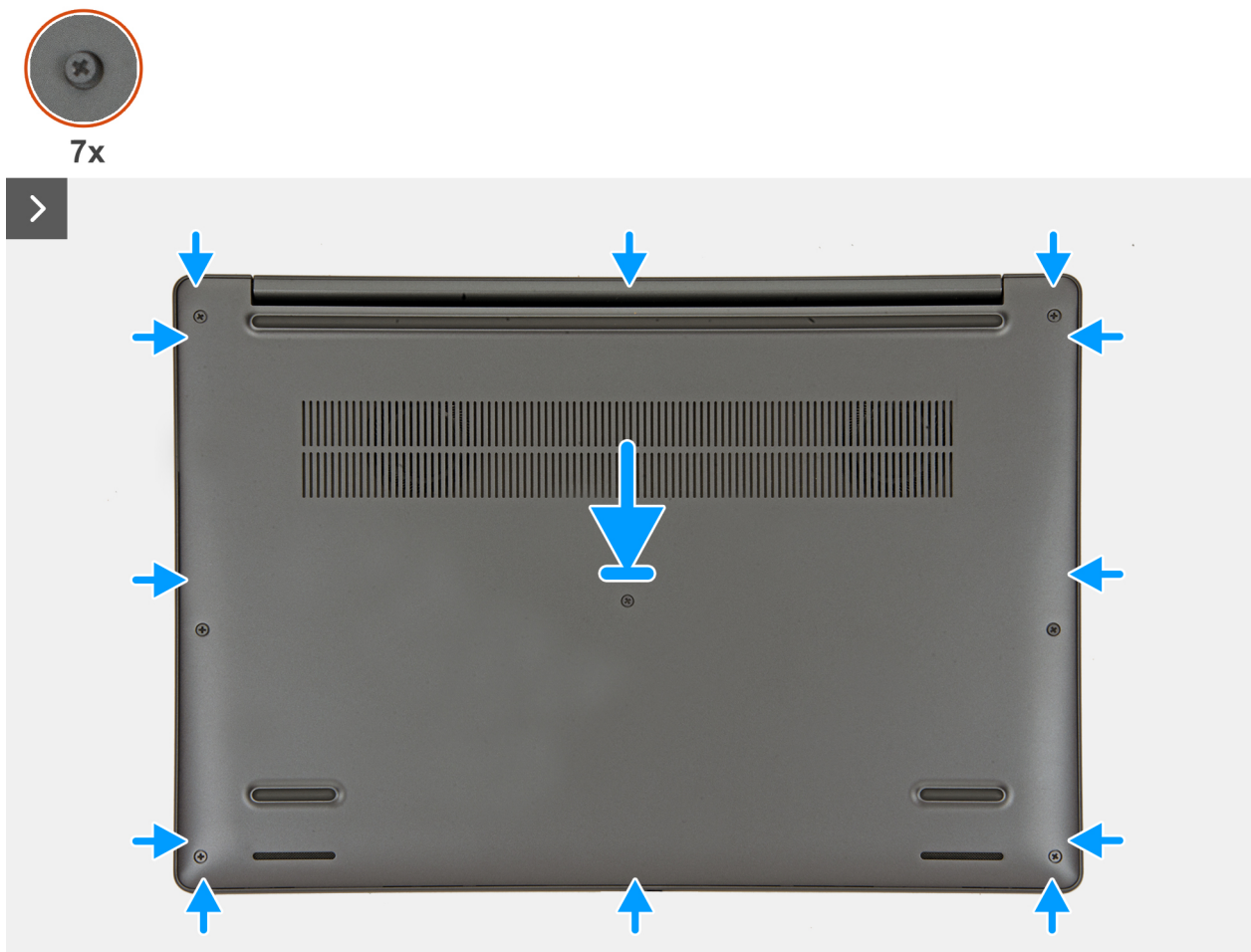
איור 18. Installing the base cover
