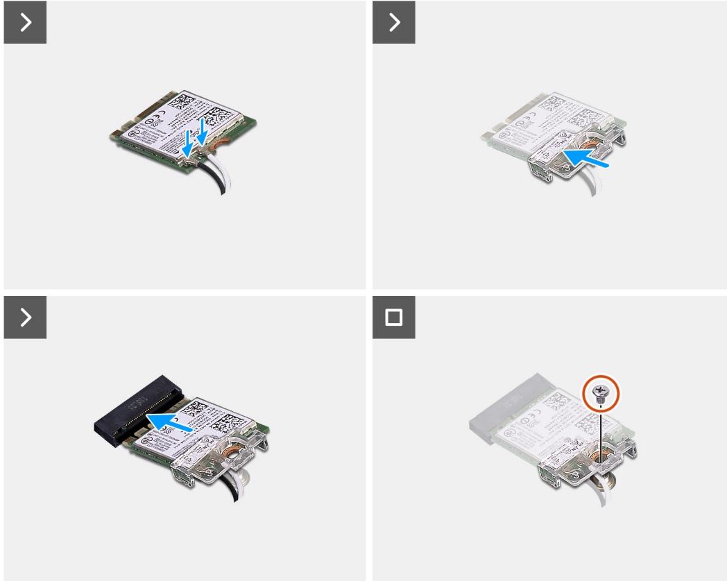
איור 105. Installing the wireless card
