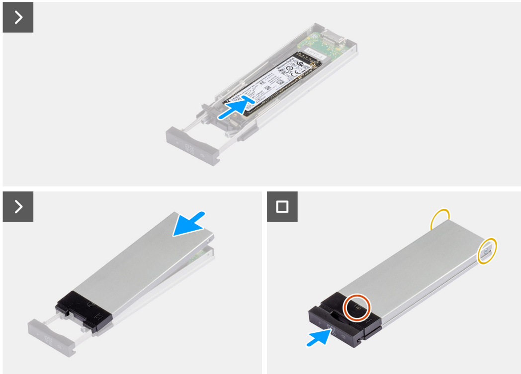
איור 36. התקנת כונן ה-solid-state החיצוני מסוג M.2 2280
