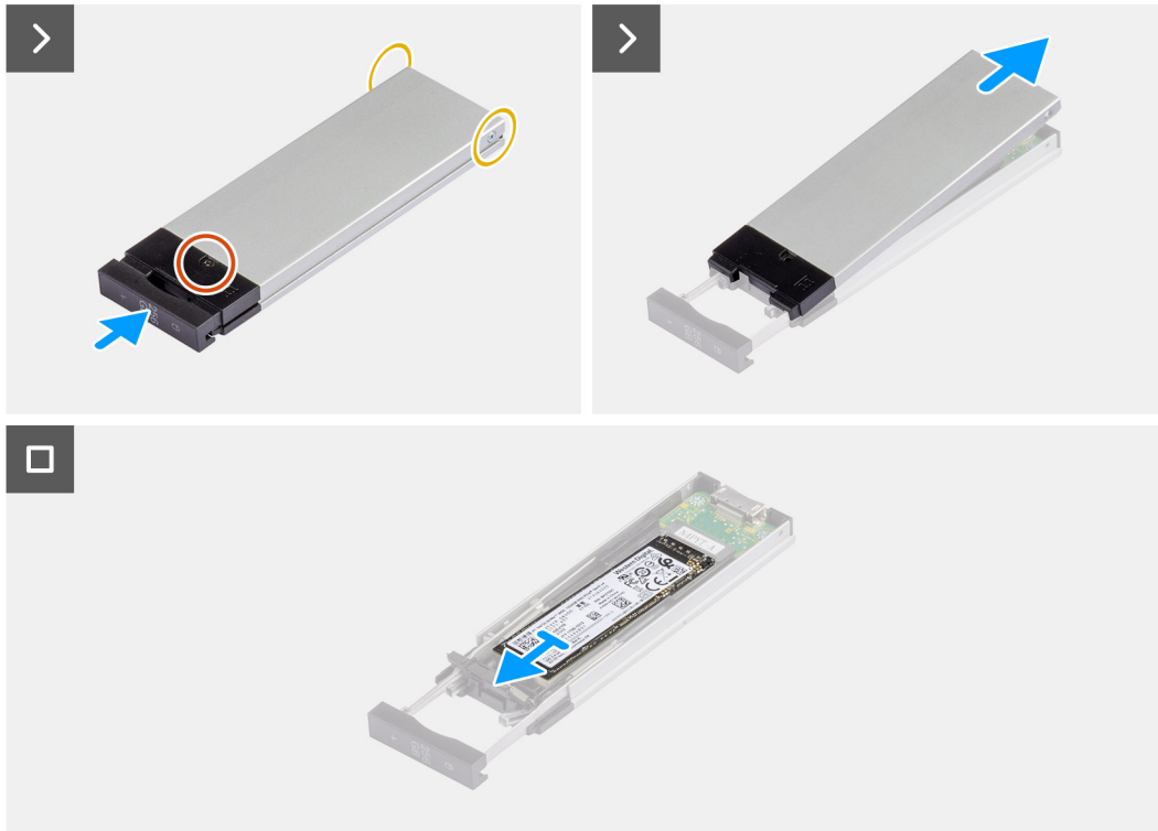
איור 35. הסרת כונן Solid-State חיצוני מסוג M.2 2280
