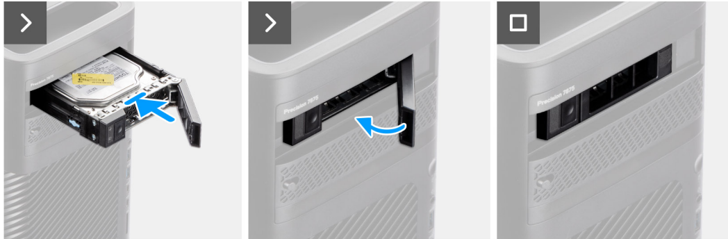
איור 29. התקנת מכלול הכונן הקשיח החיצוני בגודל 3.5 אינץ'
