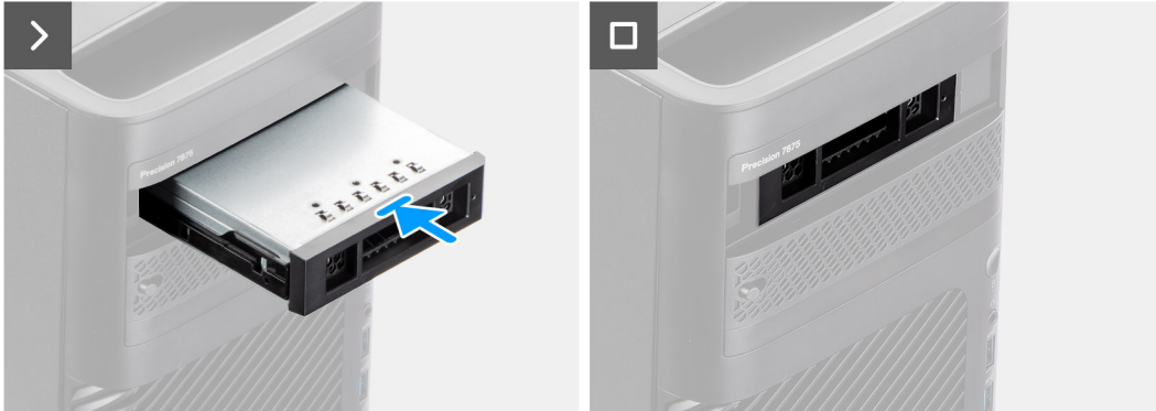
איור 31. התקנת הכלוב של כונן ה-Solid-State החיצוני
