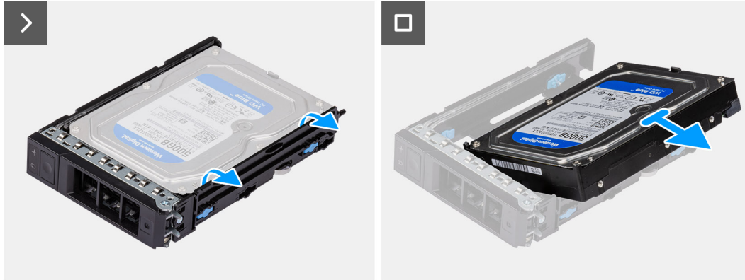
איור 27. הסרת כונן קשיח בגודל 3.5 אינץ' ממכלול הכונן הקשיח החיצוני
