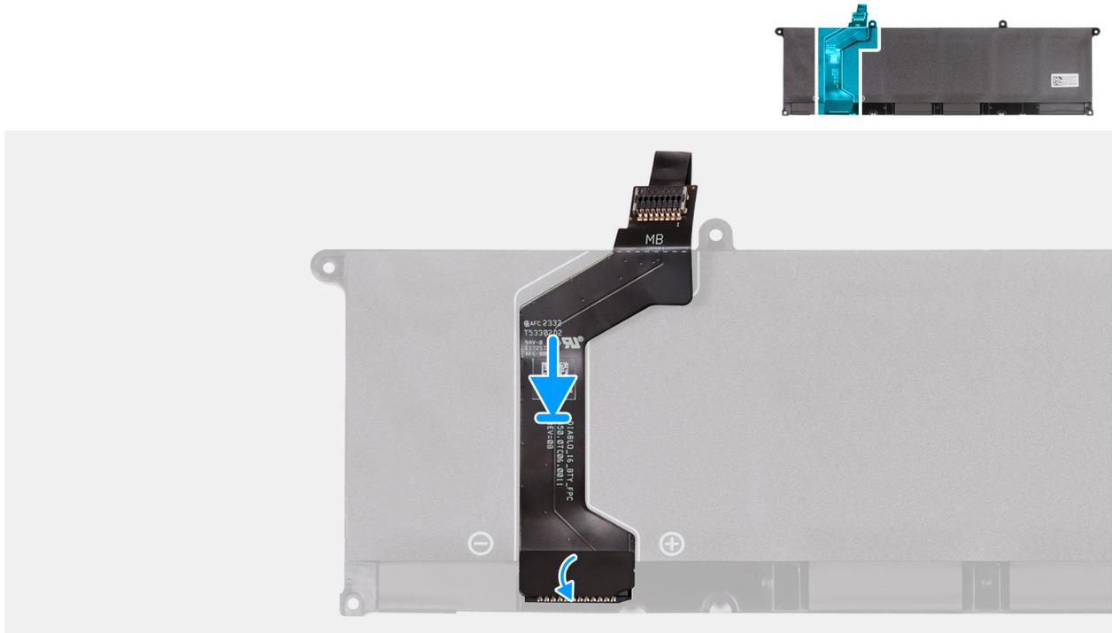
Figure 22. Installation du câble de la batterie
