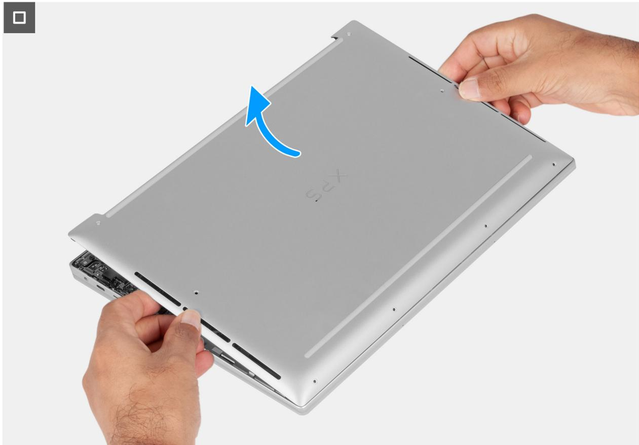
**Abbildung 16. Entfernen der Bodenabdeckung**
