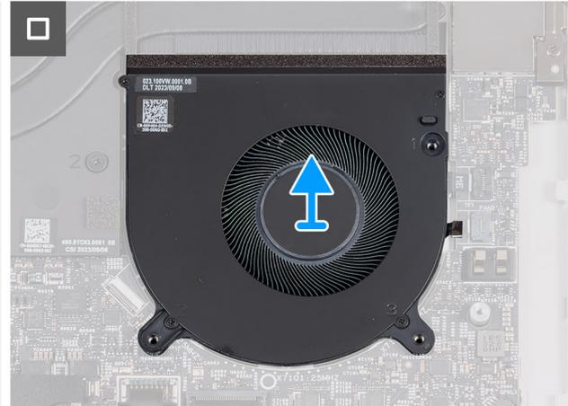
Abbildung 25. Entfernen des CPU-Lüfters
