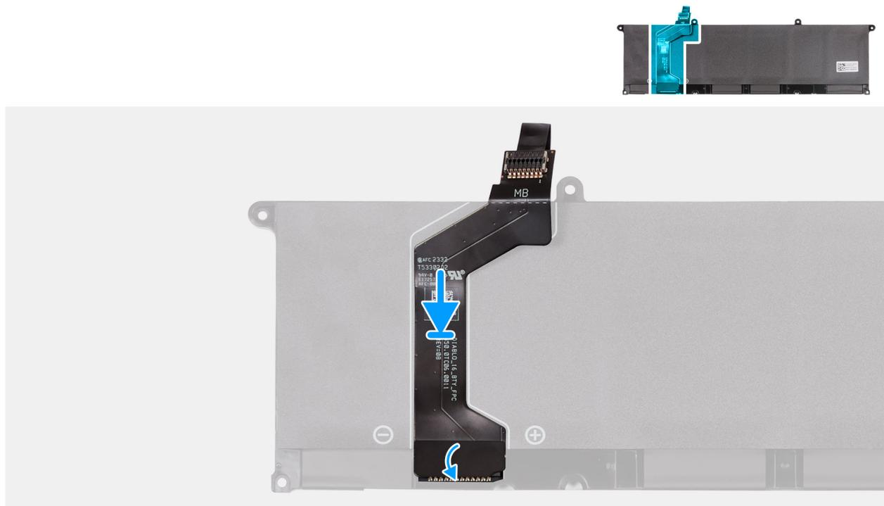
Abbildung 22. Einsetzen des Akkukabels
