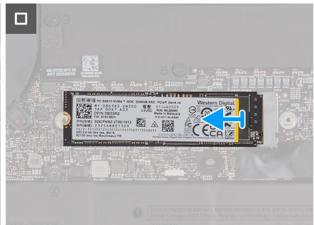
Abbildung 28. Entfernen des M.2-2280-Solid-State-Laufwerks
