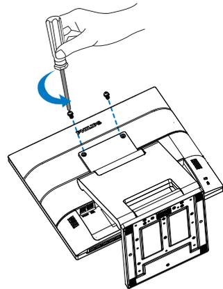
2. Mueva el soporte a la posición mostrada en la imagen. A continuación use el destornillador para quitar los tornillos y separe el soporte del monitor.
