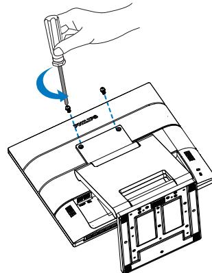
2. Stojan umiestnite do polohy podľa obrázka. Potom skrutkovačom odskrutkujte skrutky a odpojte stojan od monitora.
