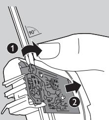
**3** Пъхнете отвертката в малкия прорез на печатната платка, обозначен със стрелка (1). Натиснете отвертката надолу, докато част от печатната платка се отчупи (2).
