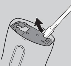
**3** Umetnute odvijač u mali otvor na ploči sa sklopom označen strelicom (1). Pritisnite odvijač dok se dijelovi ploče ne odlome (2).
