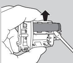
**3** Vložte šroubovák do malé drážky na tištěném obvodu, označené šípkou (1). Zatlačte šroubovákom, dokud se části tištěného obvodu nepřeruší (2).
