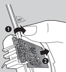
**2** Sejměte epilační hlavu a otevřete přístroj pomocí šroubováku.
