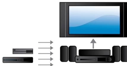
El hub HDMI proporciona puertos HDMI adicionales para que puedas conectar otros dispositivos, como la videoconsola o el sintonizador de alta definición, al cine en casa cómodamente. Al conectar los dispositivos mediante el hub HDMI, puedes disfrutar del sonido y la imagen en alta definición para todo el entretenimiento.
