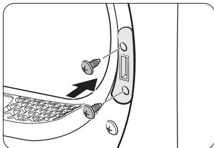
9. Inserire il fermo della leva sulla cornice destra e serrare le due viti del fermo.
