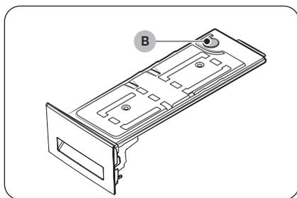
2. Vuotare l'acqua mediante il **tubo di scarico (B)** e pulire l'interno.
