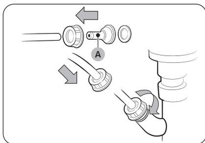
1. Montare il **connettore del tubo (A)** e fissarlo all'estremità del tubo accessorio come mostrato in figura.
