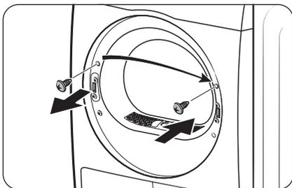
5. Rimuovere la vite superiore della cornice dello sportello sulla sinistra della cornice stessa, quindi inserirla nel foro destro della cornice dello sportello. Non rimuovere le viti della staffa inferiore.
