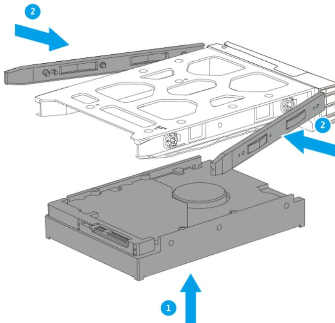
**d.** Bringen Sie die Schrauben an, um das Laufwerk weiter zu sichern.
