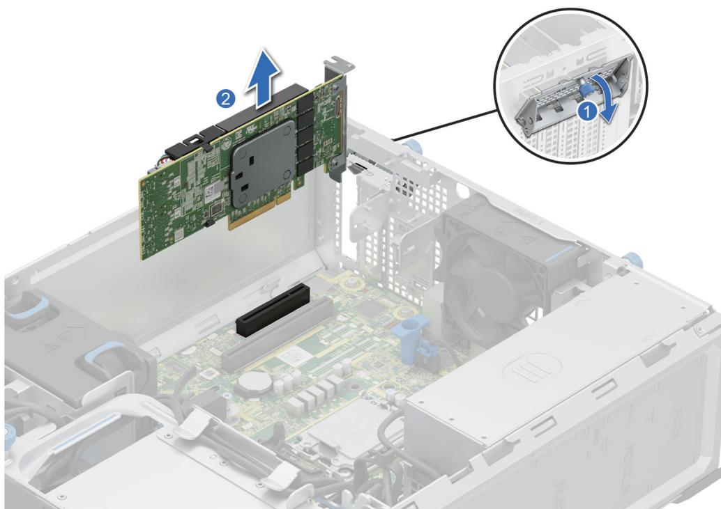
**Ilustración 43. Extracción de una tarjeta de expansión**
