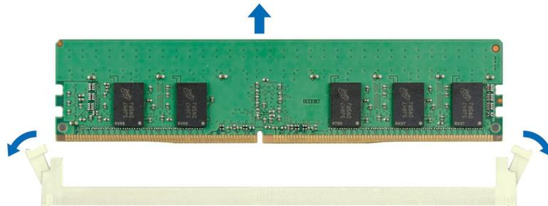
**Ilustración 35. Extracción de un módulo de memoria**
