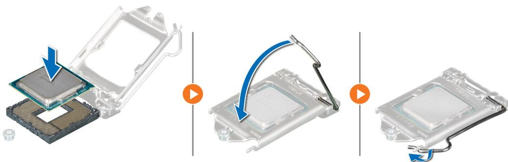
Ilustración 39. Instalación del procesador
