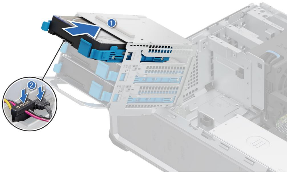
Ilustración 21. Instalación de un portaunidades
