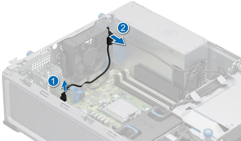
**Ilustración 16. Extracción del módulo del switch de intrusión**
