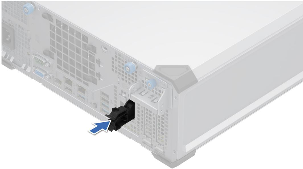
**Ilustración 53. Instalación del portaunidades de tarjeta BOSS-N1 de relleno**
