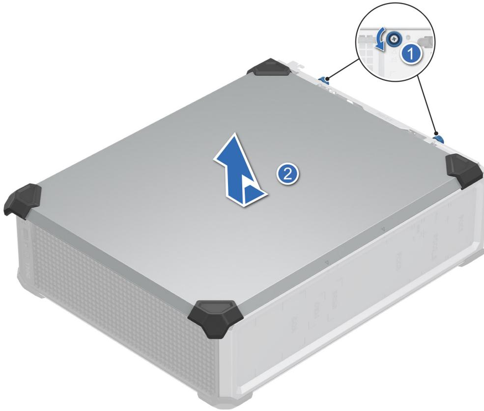
**Ilustración 12. Extracción de la cubierta del sistema**
