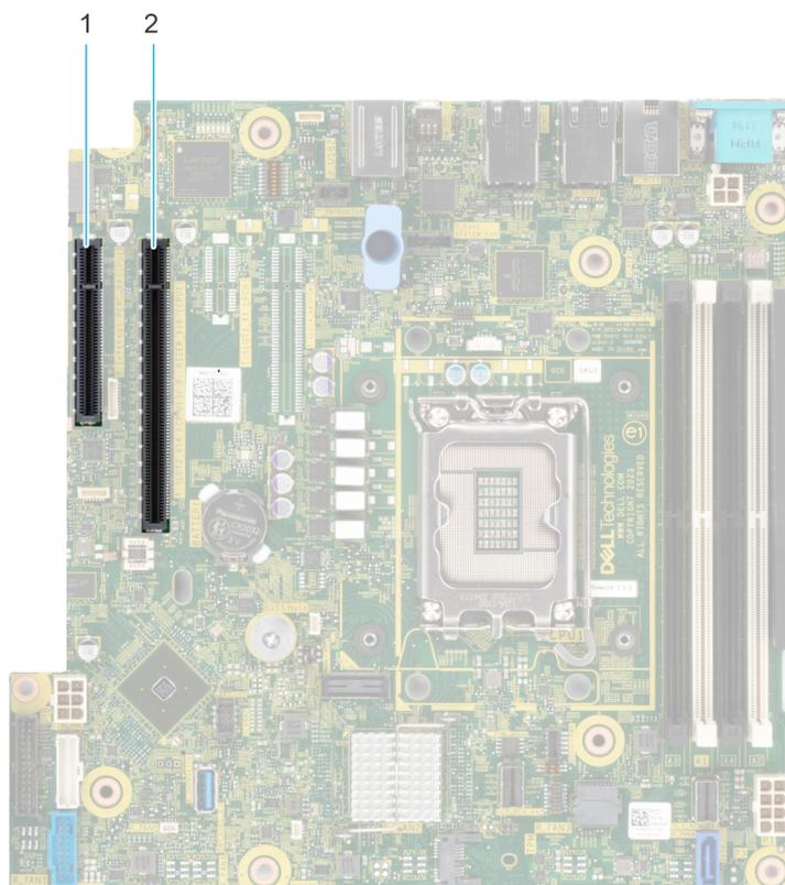
**Ilustración 42. Ranuras del conector de PCIe en la tarjeta madre**
