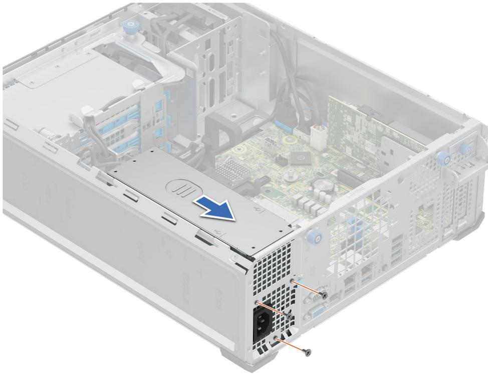
**Ilustración 58. Instale la PSU cableada.**
