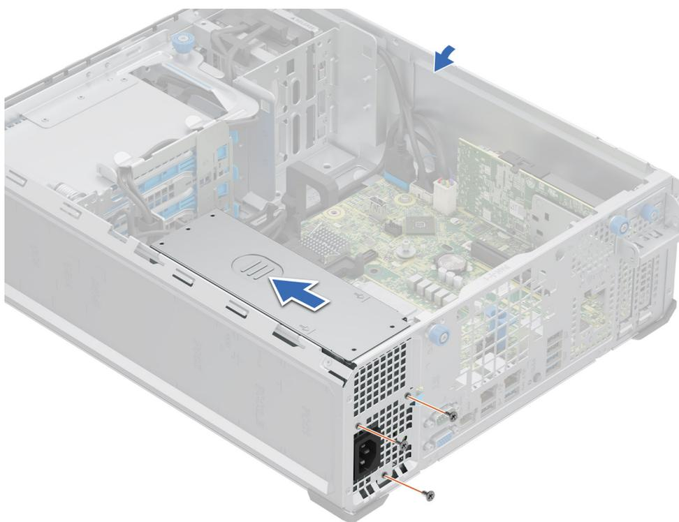
**Ilustración 57. Extracción de la PSU cableada**
