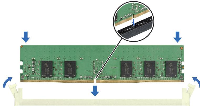
**Ilustración 36. Instalación de un módulo de memoria**
