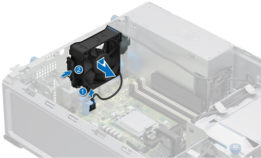
**Ilustración 26. Extracción del ventilador de enfriamiento**
