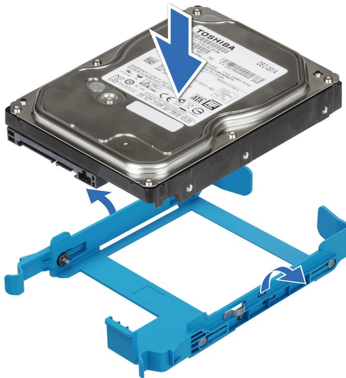
Ilustración 25. Instalación de una unidad en el portaunidades
