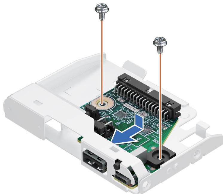
**Ilustración 68. Instalación del ensamblaje del panel de control**
