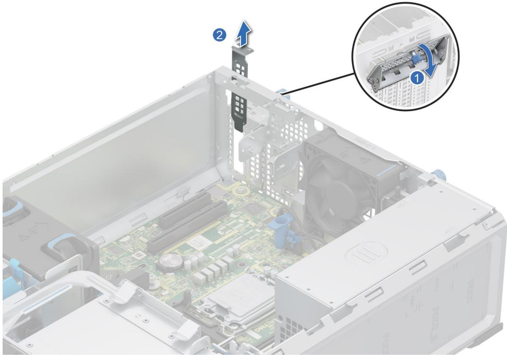
**Ilustración 45. Extracción del soporte de relleno metálico**
