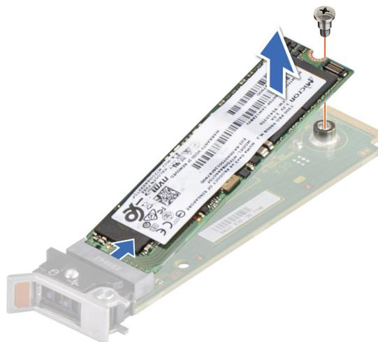
**Ilustración 52. Extracción de la SSD NVMe M.2**
