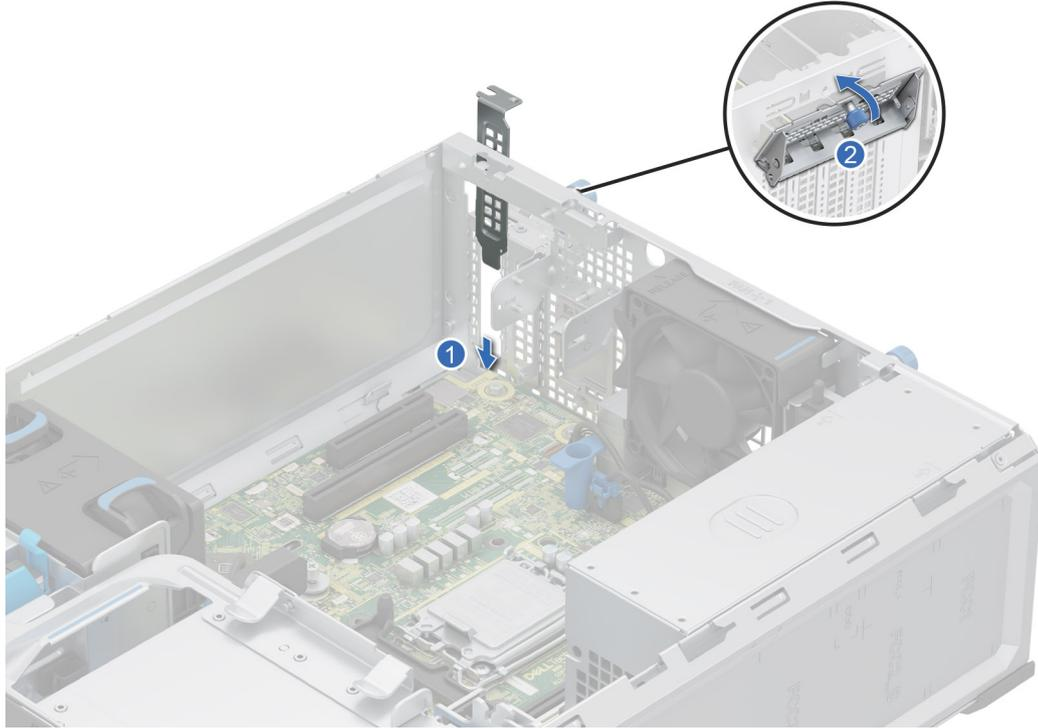
**Ilustración 44. Instalación del soporte de relleno metálico**
