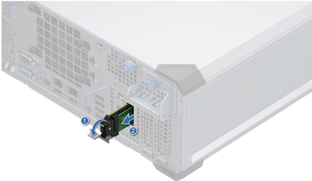
**Ilustración 51. Extracción del portatajadas de tarjeta BOSS-N1**
