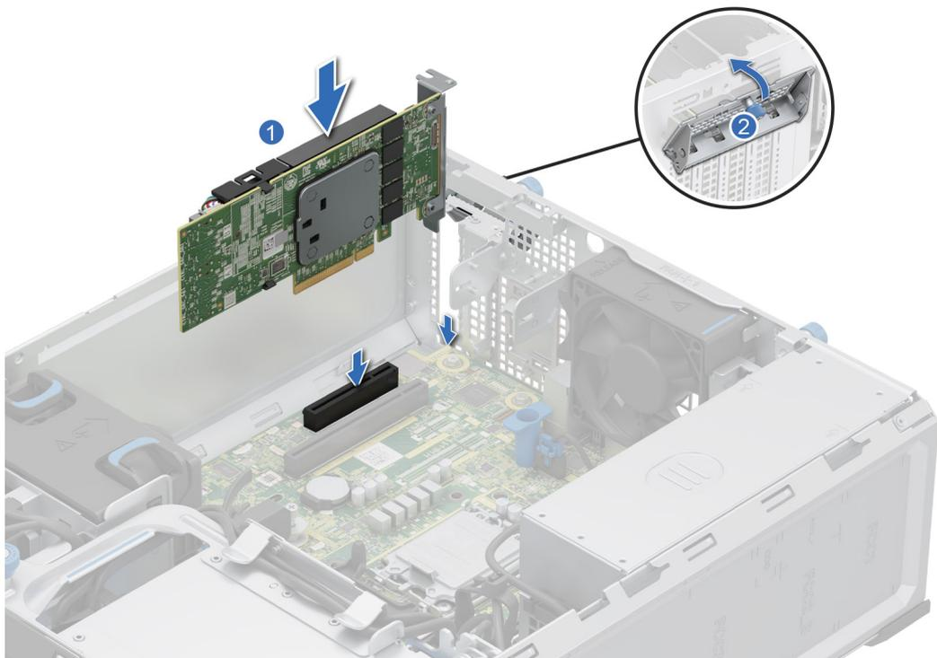
**Ilustración 46. Instalación de una tarjeta de expansión**
