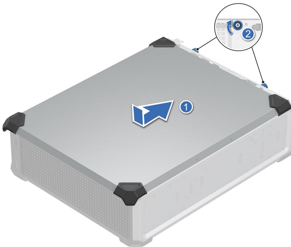
**Ilustración 13. Instalación de la cubierta del sistema**
