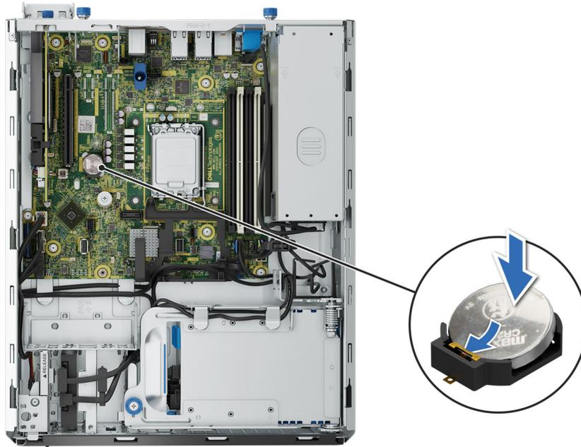
**Ilustración 60. Instalación de la batería del sistema**
