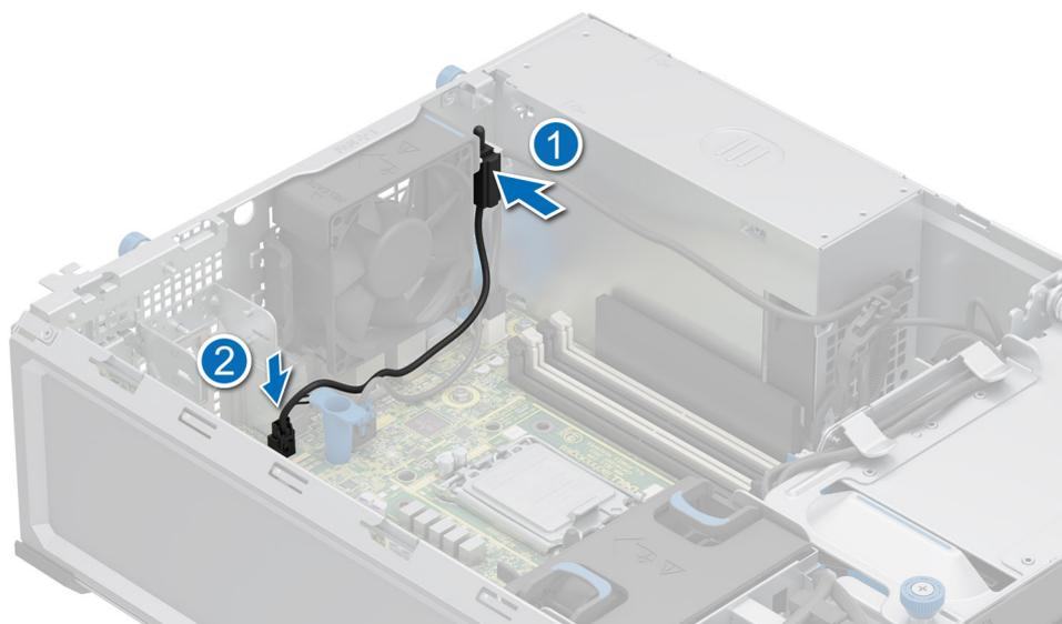
**Ilustración 17. Instalación del módulo del switch de intrusión**
