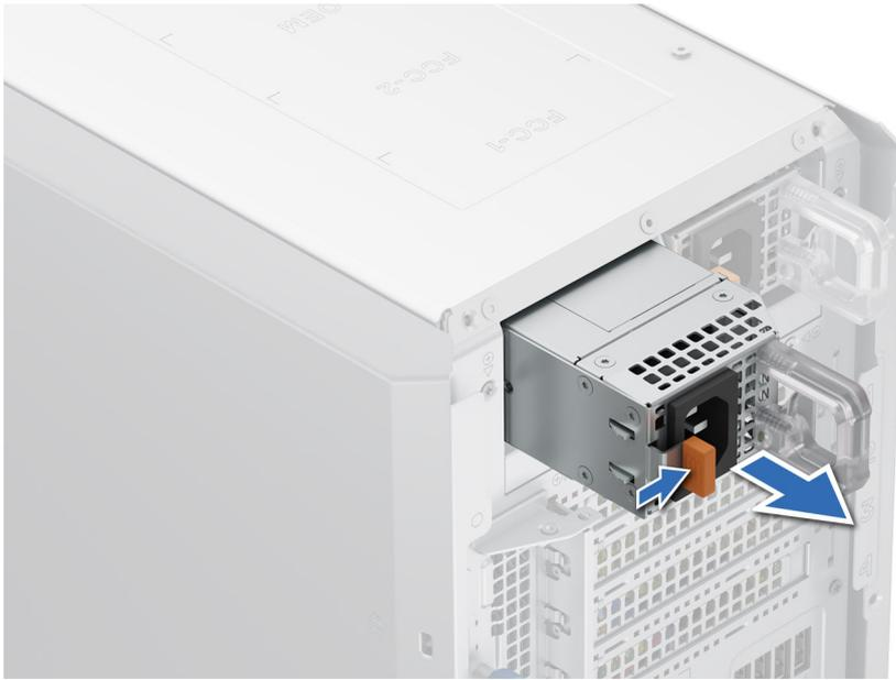
**Ilustración 78. Extracción de una fuente de alimentación**
