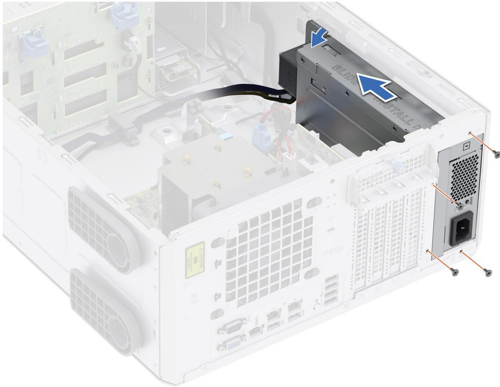
**Ilustración 80. Extracción de la canastilla de la PSU**
