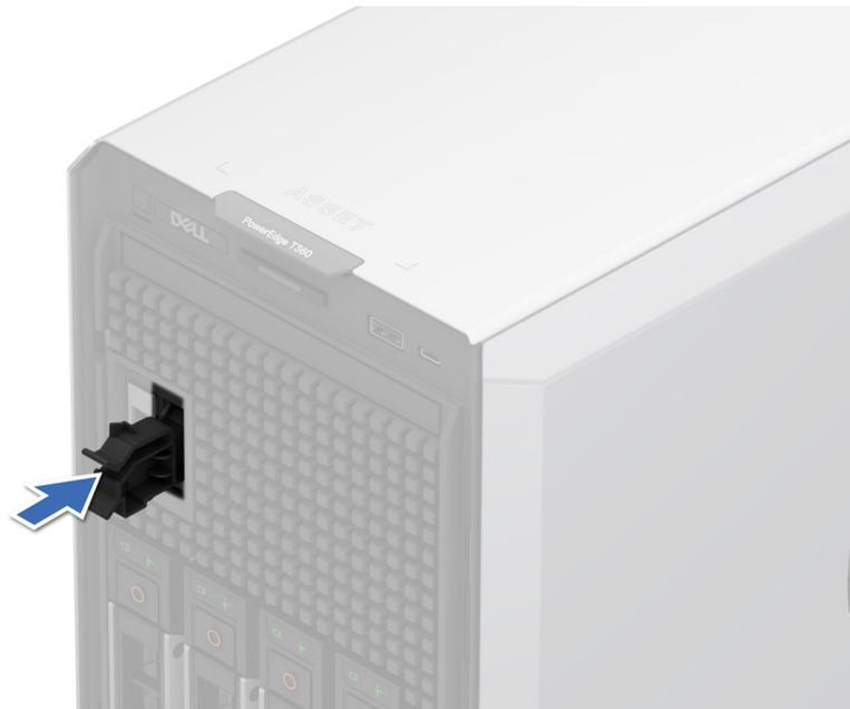
**Ilustración 72. Instalación del portaunidades de tarjeta BOSS-N1 de relleno**
