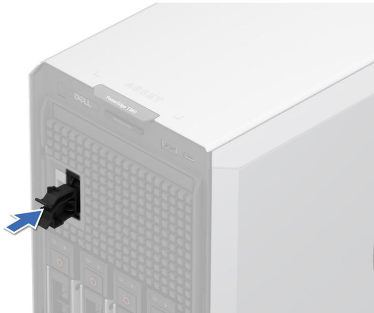
**Ilustración 100. Instalación del módulo de BOSS-N1 de relleno**
