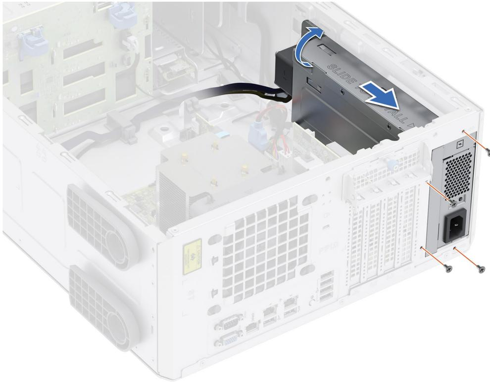
**Ilustración 83. Instalación de la canastilla de la PSU**
