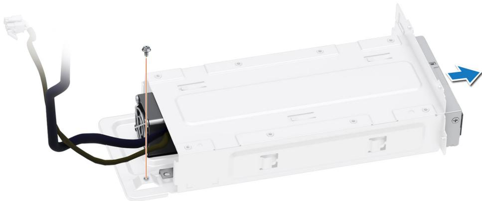
**Ilustración 81. Extracción de la PSU cableada**
