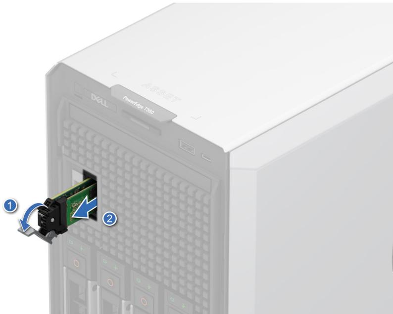
**Ilustración 70. Extracción del portaunidades de tarjeta BOSS-N1**
