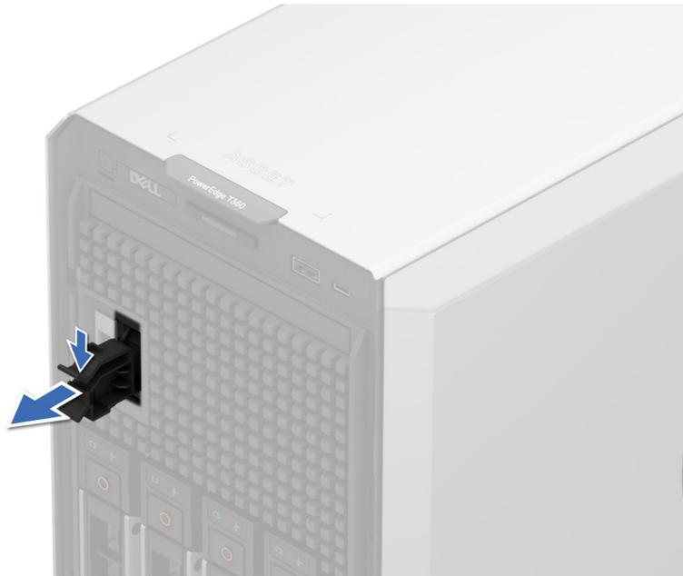
**Ilustración 99. Extracción del módulo de BOSS-N1 de relleno**
