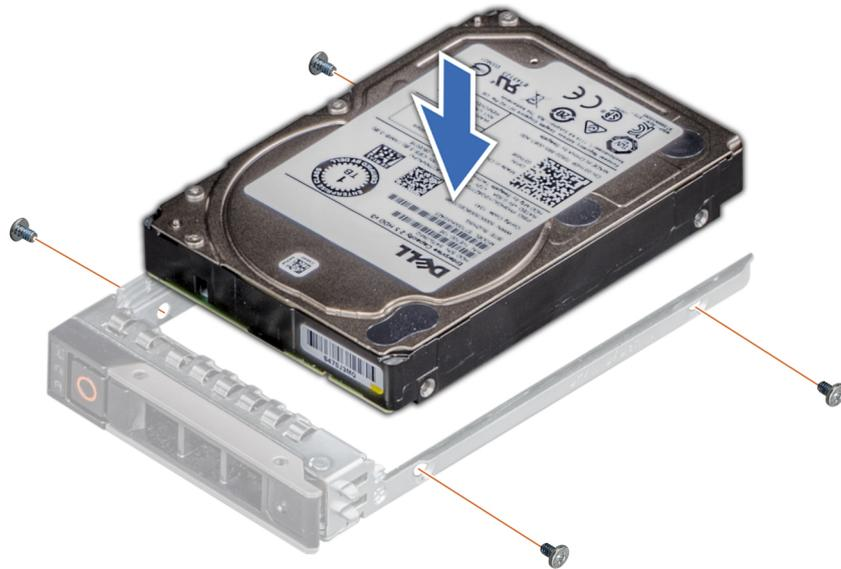
**Ilustración 29. Instalación de una unidad en el portaunidades**
