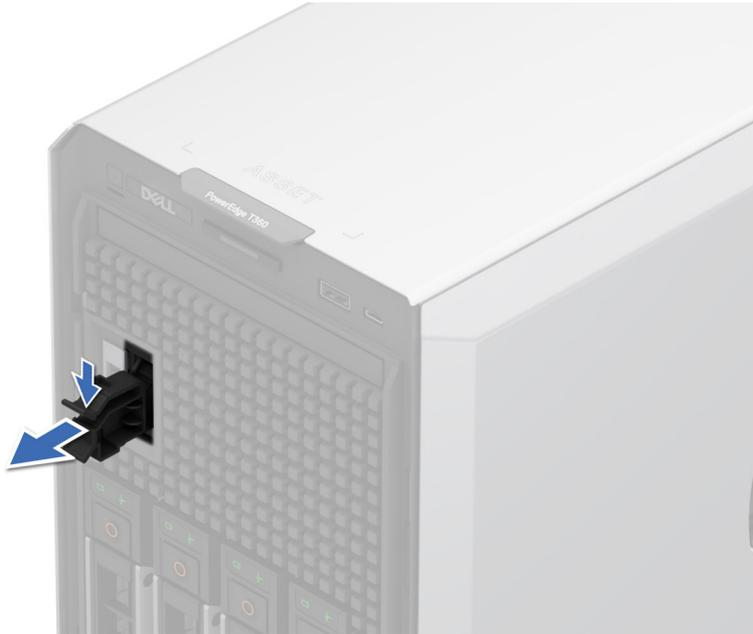
**Ilustración 68. Extracción del módulo de BOSS-N1 de relleno**
