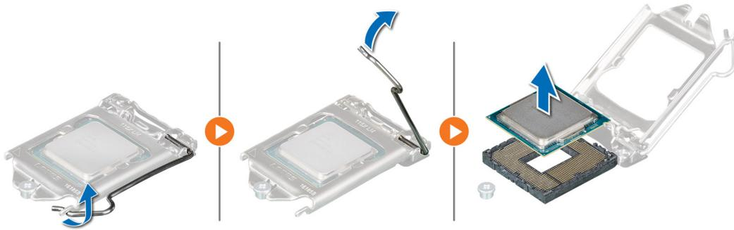
Ilustración 53. Extracción del procesador
