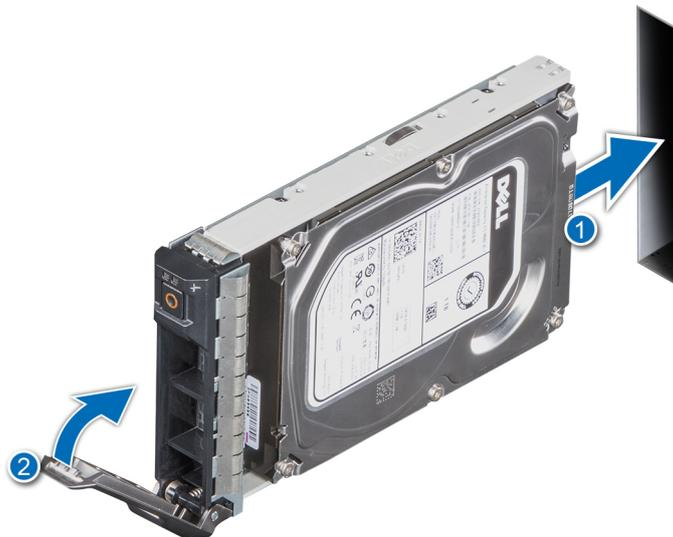
**Ilustración 27. Instalación de un portaunidades**
