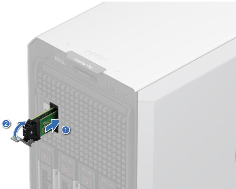
**Ilustración 75. Instalación del portatarjetas de BOSS-N1**
