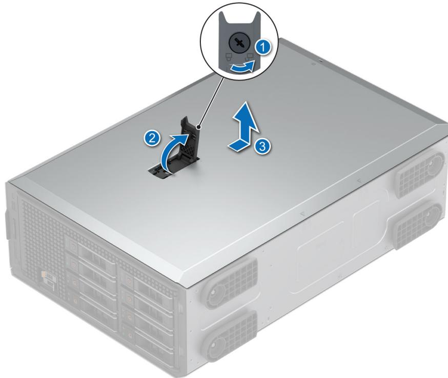
Ilustración 16. Extracción de la cubierta del sistema
