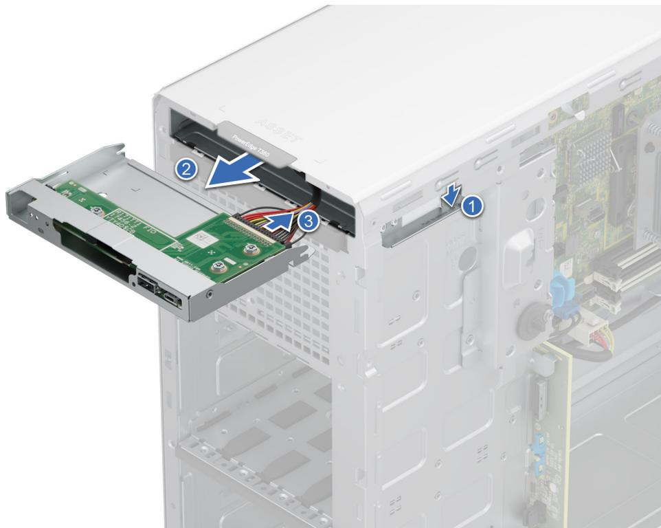
**Ilustración 93. Extracción de la canastilla del panel de control**
