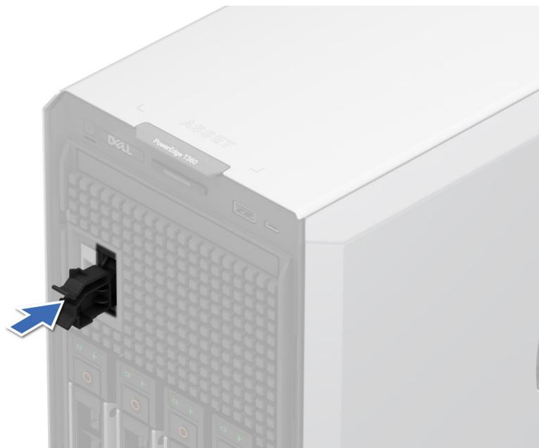
**Ilustración 67. Instalación del módulo de BOSS-N1 de relleno**
