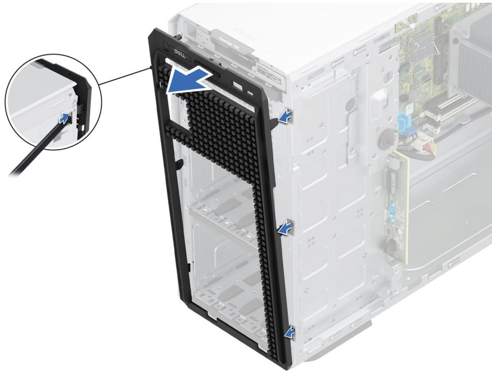
**Ilustración 92. Extracción de la placa frontal**
