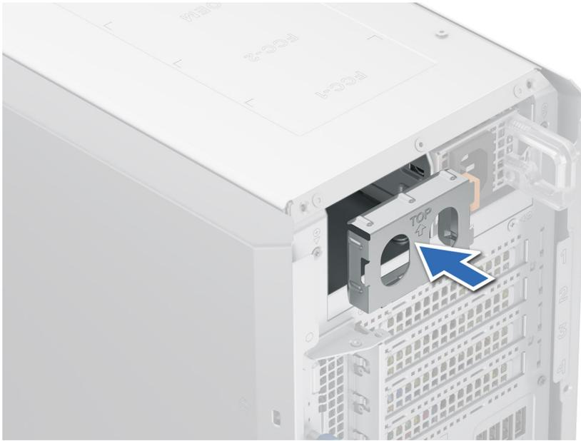
Ilustración 77. Instalación de una fuente de alimentación de relleno
