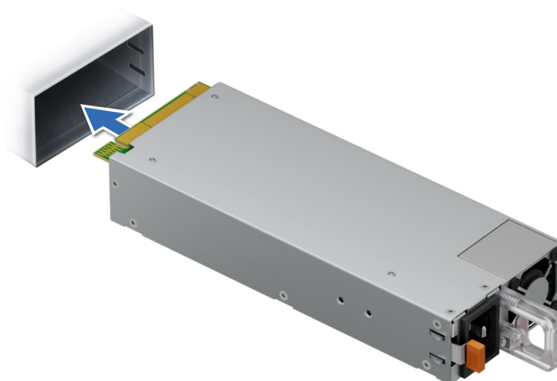
Ilustración 191. Instalación de una fuente de alimentación de 86 mm
