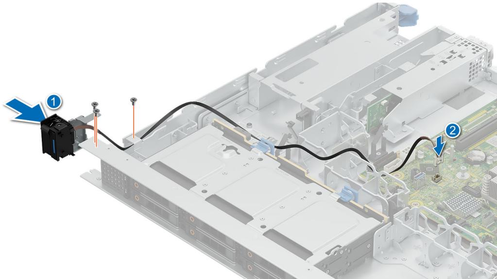
**Ilustración 97. Instalación del panel de control izquierdo**
