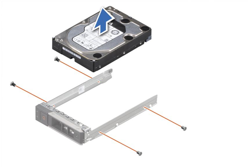
**Ilustración 50. Extracción de una unidad del portaunidades**
