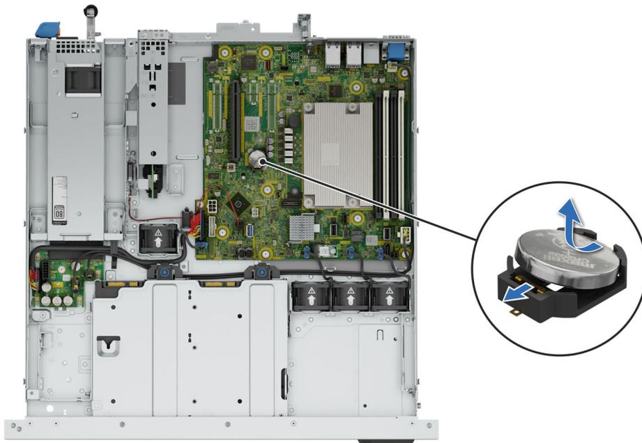
**Ilustración 81. Extracción de la batería del sistema**
