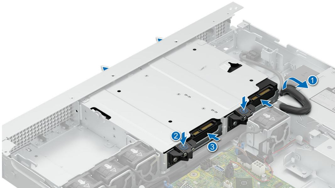
Ilustración 53. Extracción del disco duro cableado de 3,5 pulgadas
