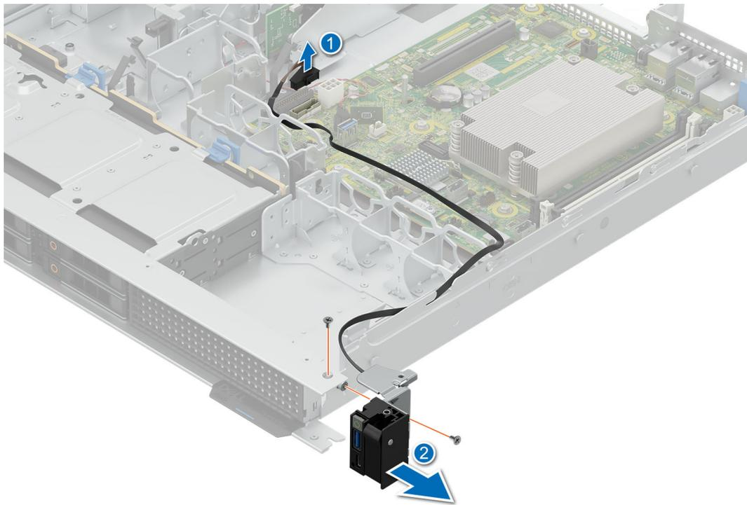
**Ilustración 94. Extracción del panel de control derecho**
