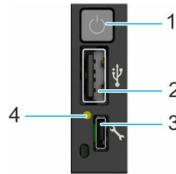
Ilustración 5. Panel de control derecho
