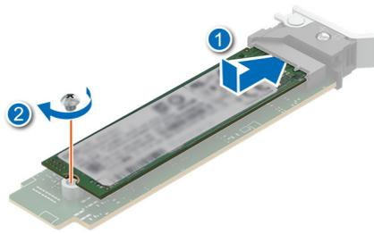
**Ilustración 79. Instalación de la SSD M.2**
