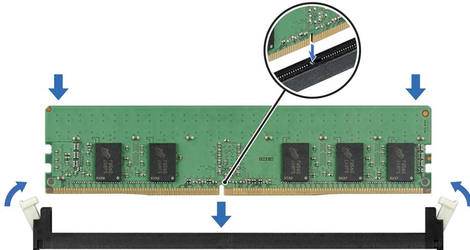
**Ilustración 57. Instalación de un módulo de memoria**
