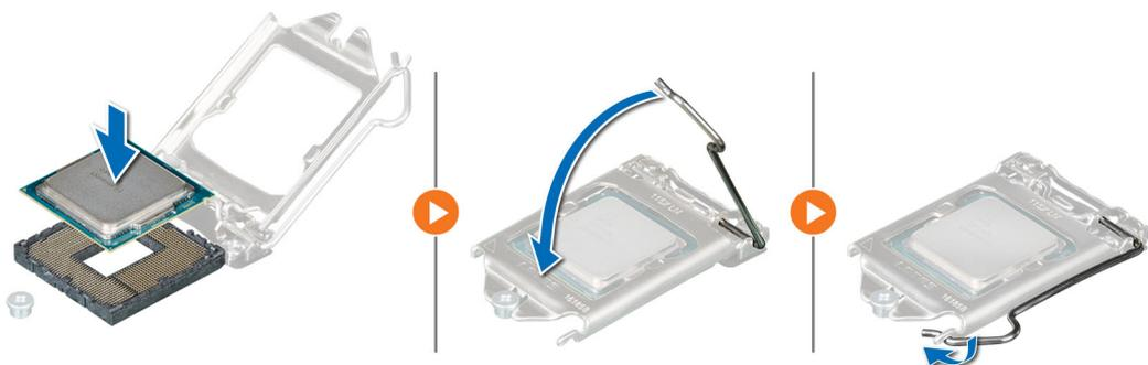
**Ilustración 60. Instalación del procesador**
