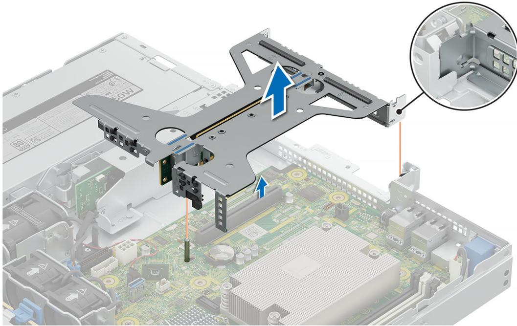
**Ilustración 66. Extracción de la tarjeta elevadora**
