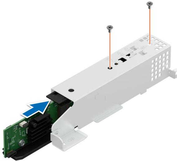
**Ilustración 77. Instalación de la tarjeta BOSS-N1**
