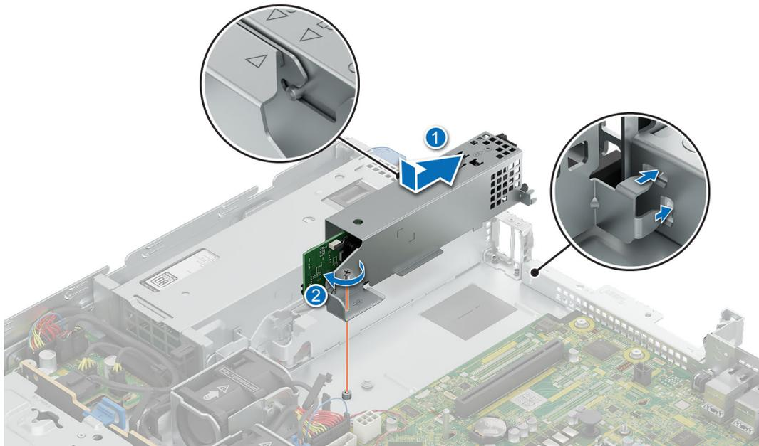
**Ilustración 78. Instalación de la canastilla para BOSS-N1**
