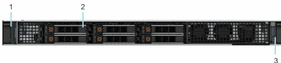
**Ilustración 3. Vista frontal de un sistema de 6 unidades de 2,5 pulgadas**
