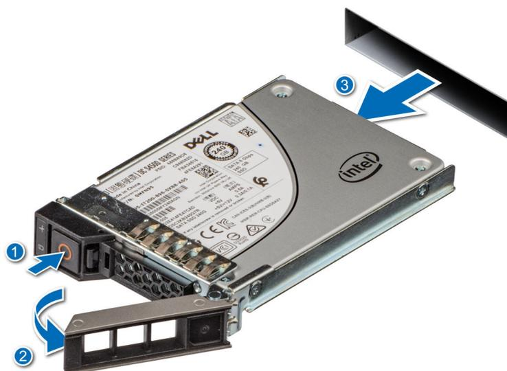
**Ilustración 49. Extracción de un portaunidades**
