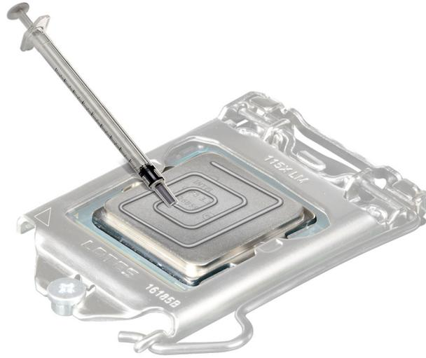
**Ilustración 61. Aplicación de la grasa térmica**
