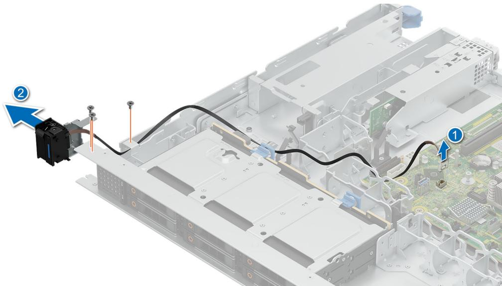
**Ilustración 96. Extracción del panel de control izquierdo**
