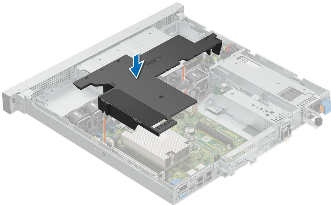
**Ilustración 30. Instalación de la cubierta para flujo de aire para la configuración de unidades de 3,5 pulgadas**
