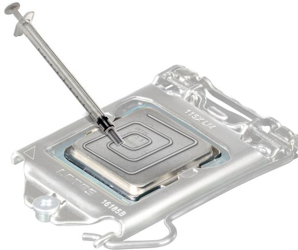
**Ilustración 62. Aplicación de la grasa térmica**
