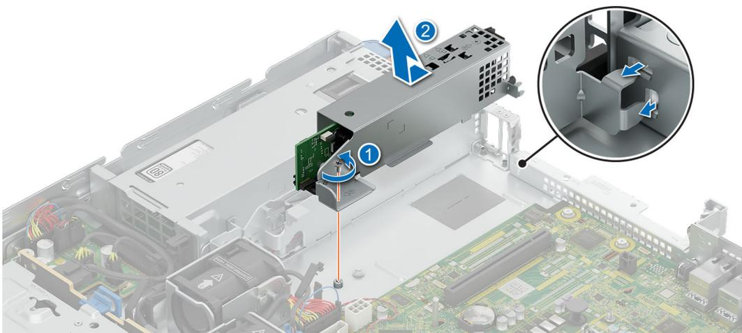
**Ilustración 74. Extracción de la canastilla para BOSS-N1**
