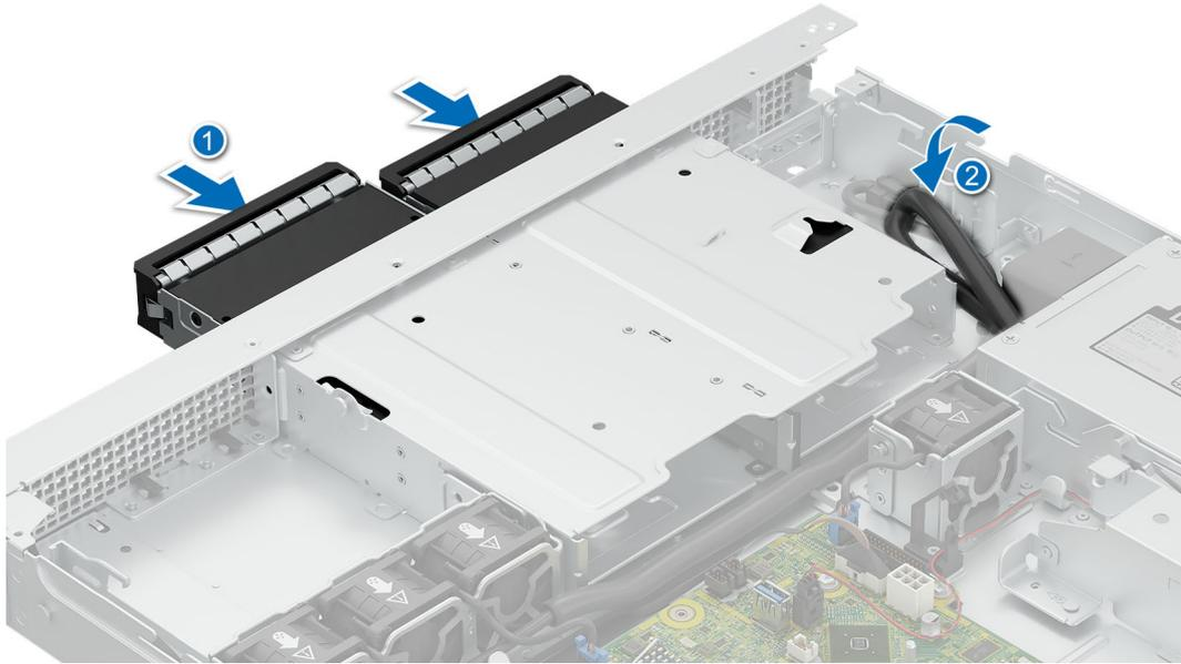
**Ilustración 54. Instalación de un disco duro cableado de 3,5 pulgadas**
