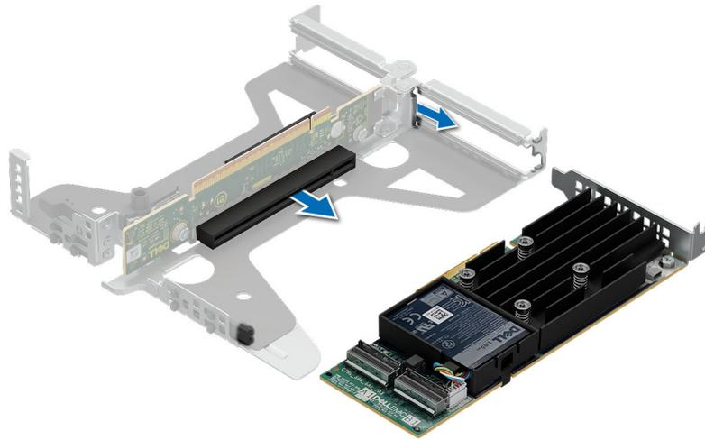
**Ilustración 67. Extracción de una tarjeta de expansión de la tarjeta elevadora**
