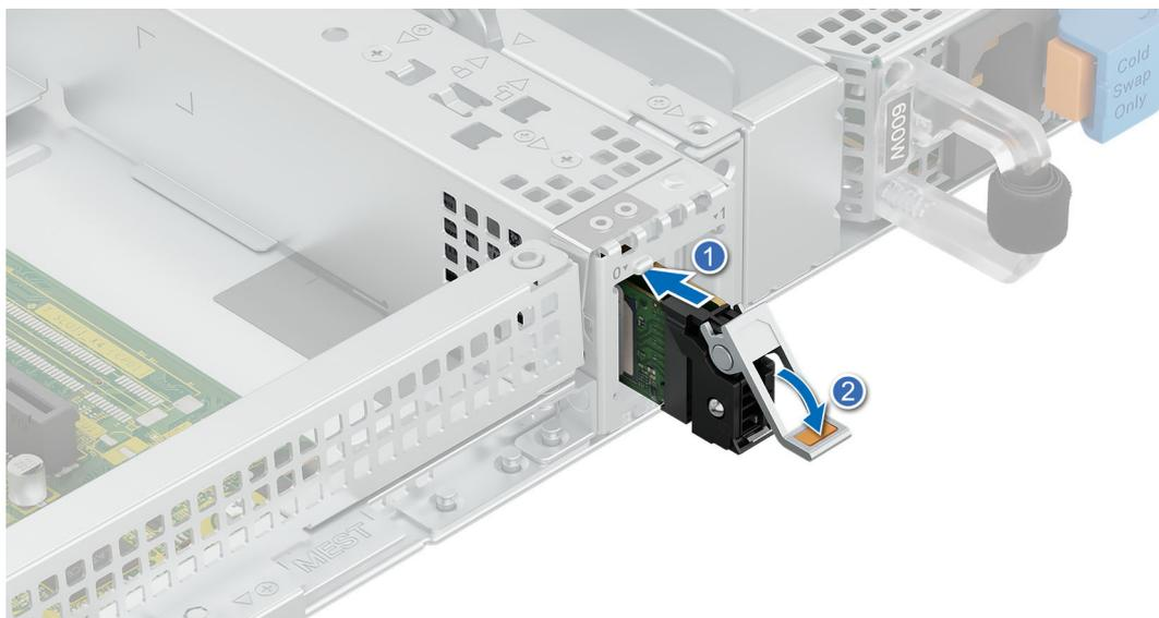
**Ilustración 80. Instalación del módulo M.2 de BOSS-N1**
