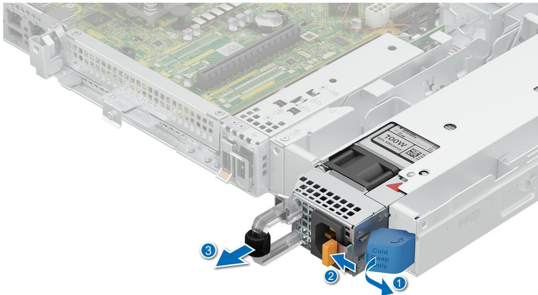
**Ilustración 87. Extracción de una unidad de fuente de alimentación no cableada**
