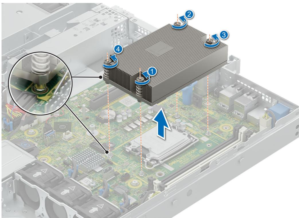
**Ilustración 58. Extracción del módulo del disipador de calor**
