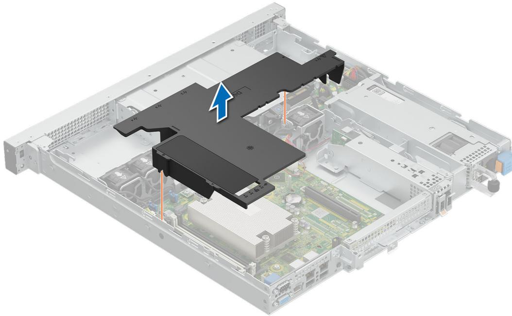
**Ilustración 28. Extracción de la cubierta para flujo de aire para la configuración de unidades de 3,5 pulgadas**
