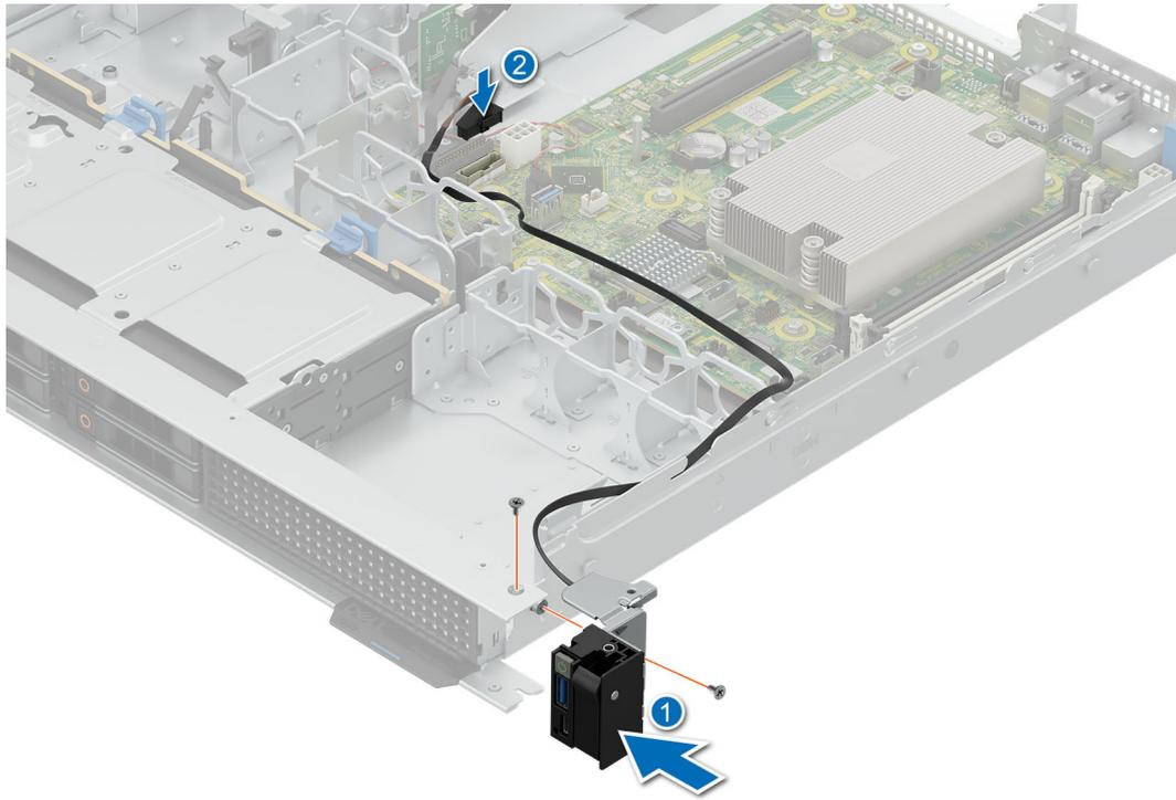
**Ilustración 95. Instalación del panel de control derecho**
