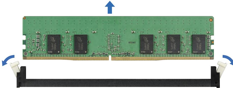
Ilustración 56. Extracción de un módulo de memoria
