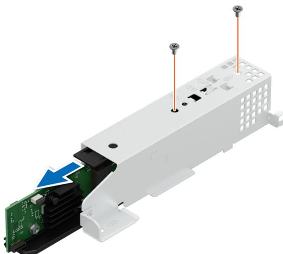
**Ilustración 75. Extracción de la tarjeta BOSS-N1**
