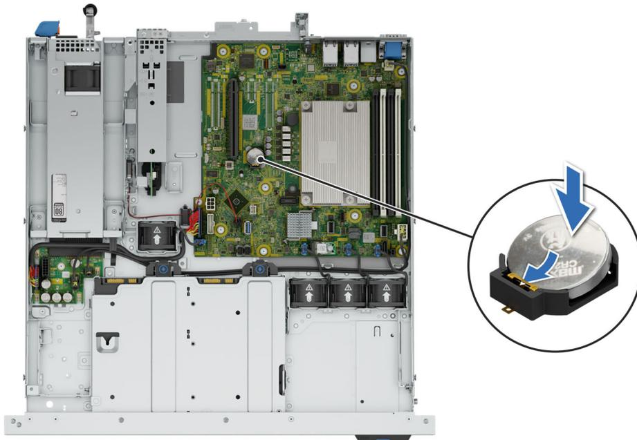
**Ilustración 82. Instalación de la batería del sistema**
