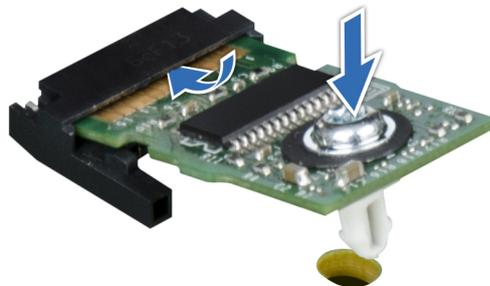
Ilustración 93. Instalación del TPM
