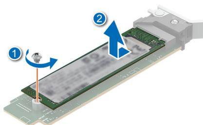
**Ilustración 76. Extracción de la SSD M.2**
