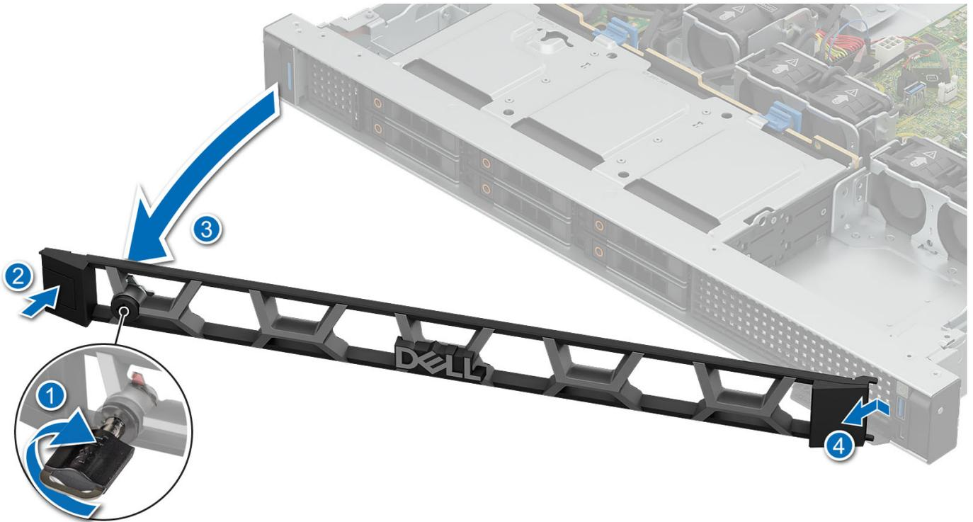
**Ilustración 23. Extracción del bisel frontal**
