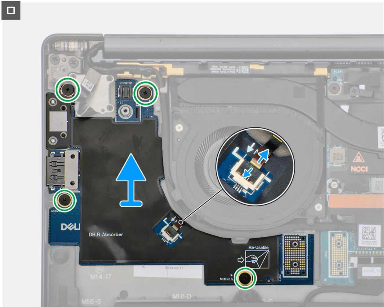
Abbildung 42. Entfernen der rechten I/O-Platine (ohne WWAN-Antennen)
