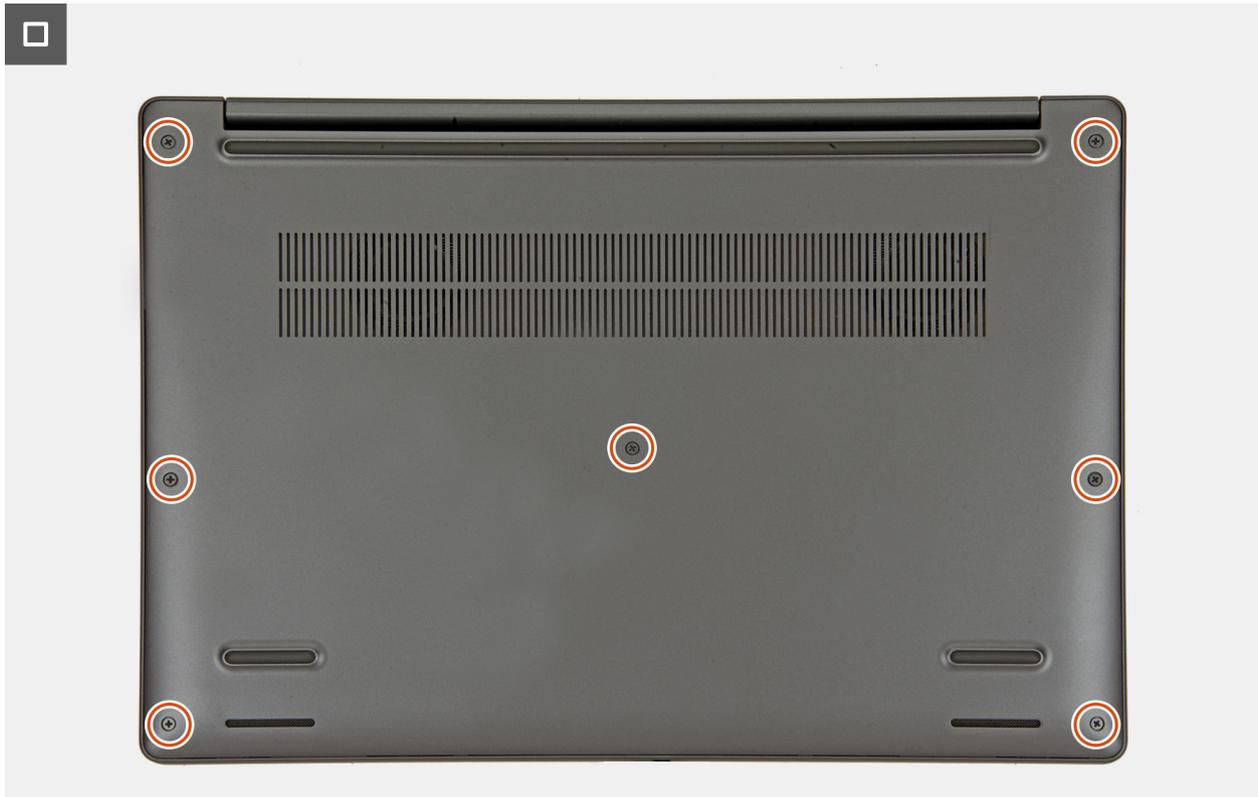
Abbildung 19. Festziehen der unverlierbaren Schrauben
