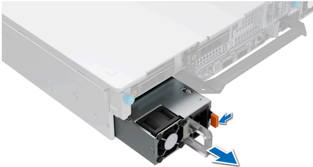
Figure 244. Retrait d'un bloc d'alimentation
