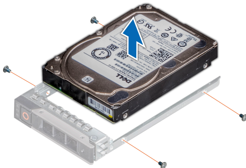
Figure 60. Retrait d'un disque dur installé de son support
