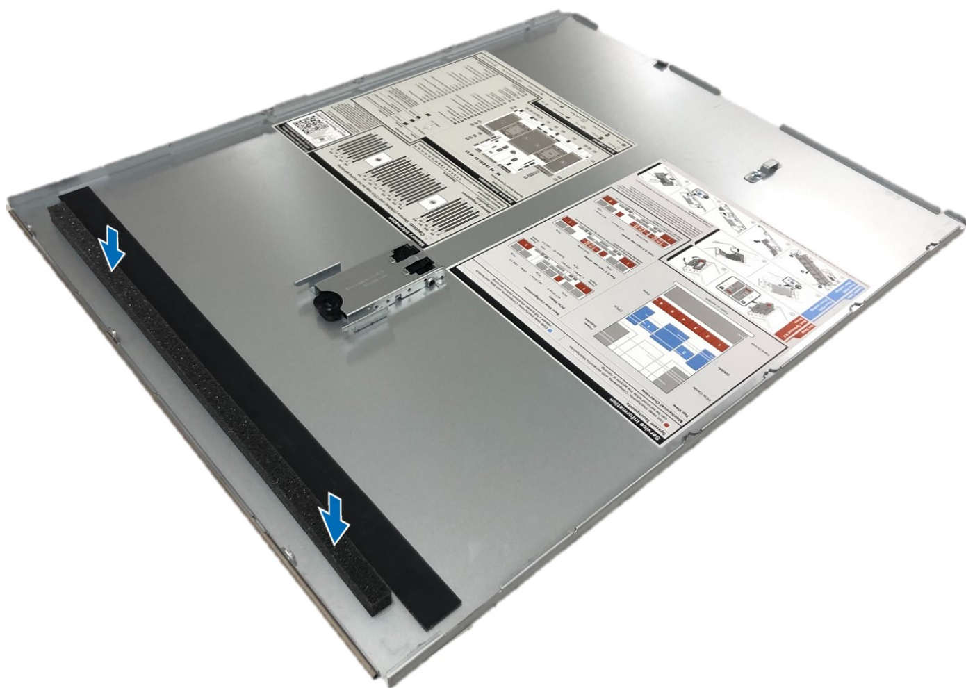
Figure 259. Installation de la mousse sur le capot du système
