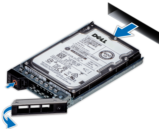
Abbildung 58. Entfernen eines Festplattenträgers
