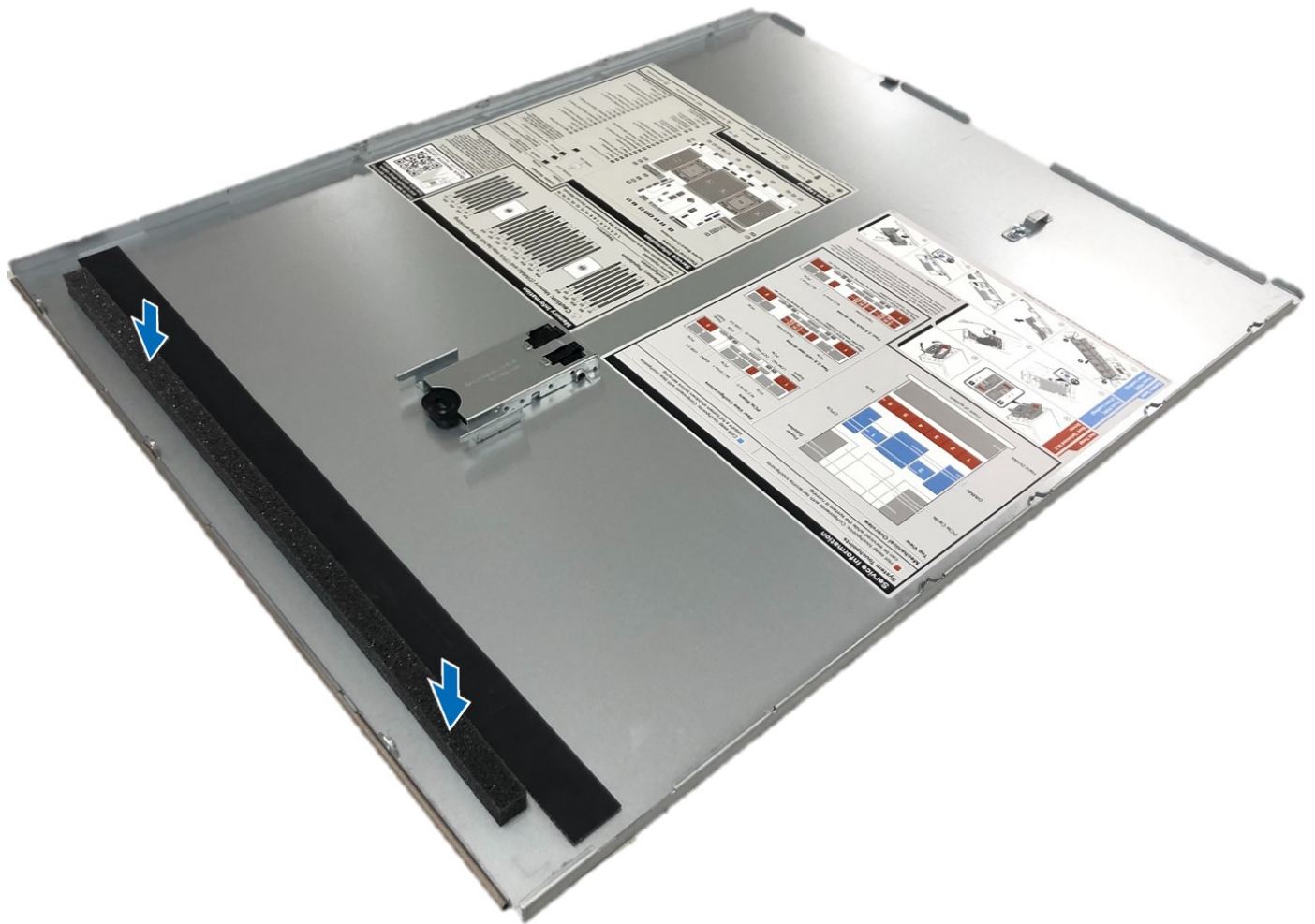
Abbildung 259. Anbringen von Schaumstoff auf der Systemabdeckung
