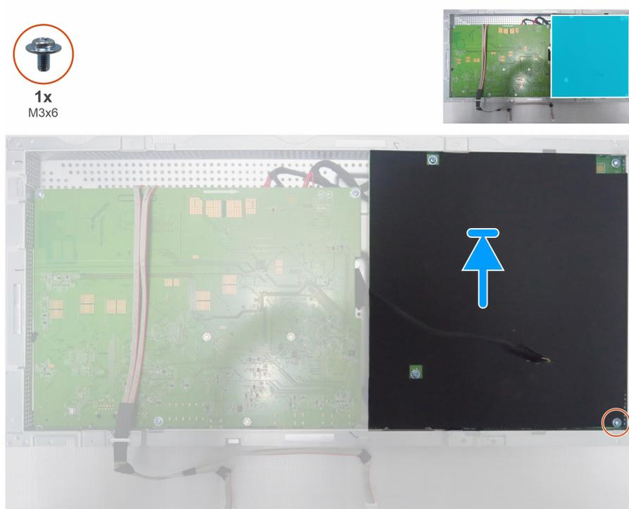
**Figura 47. Instalar a película Mylar**
