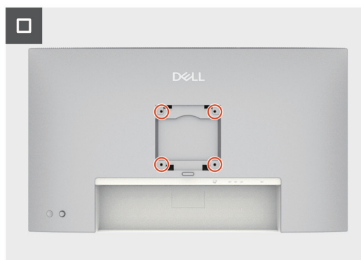
Figura 22. Installazione del coperchio posteriore superiore
