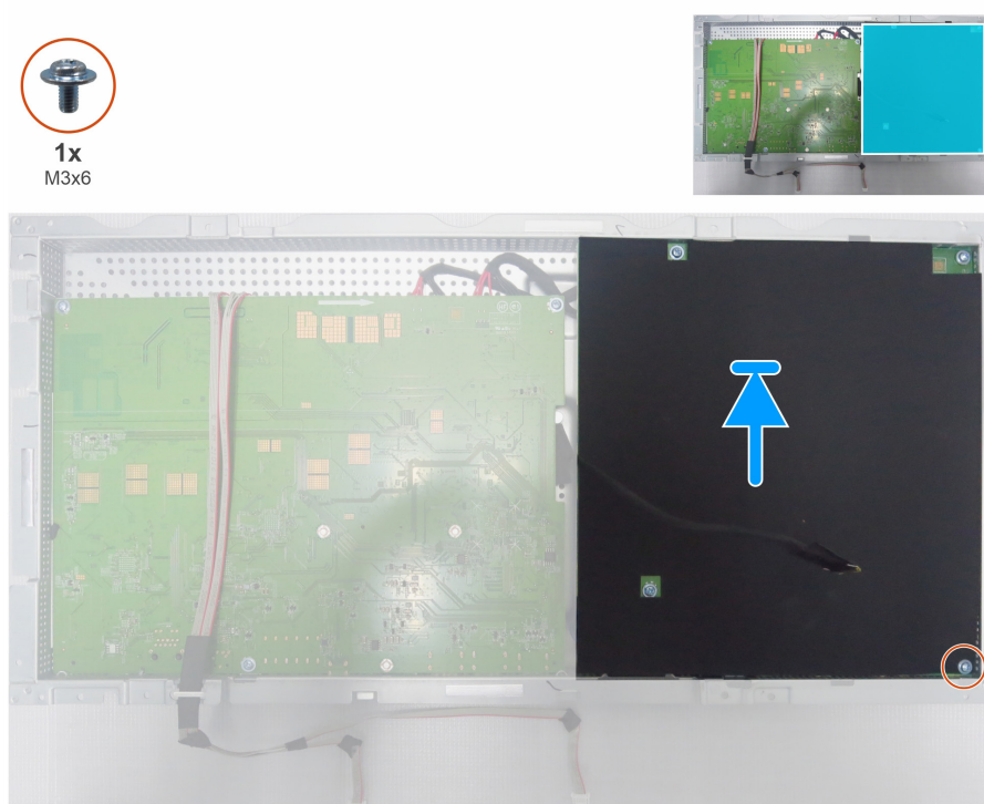
Figura 47. Installazione del foglio mylar
