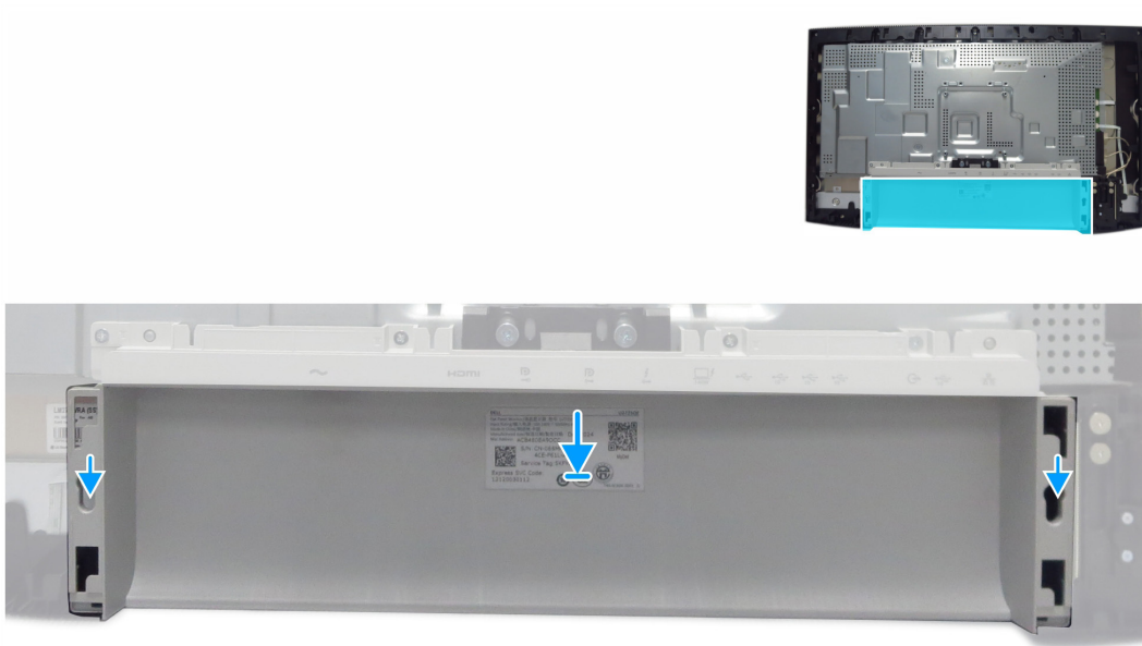
Figura 26. Installazione del coperchio posteriore inferiore
