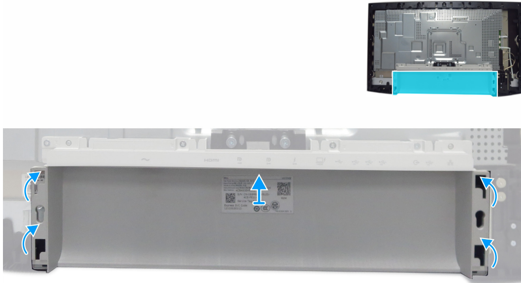
Figura 25. Rimozione del coperchio posteriore inferiore
