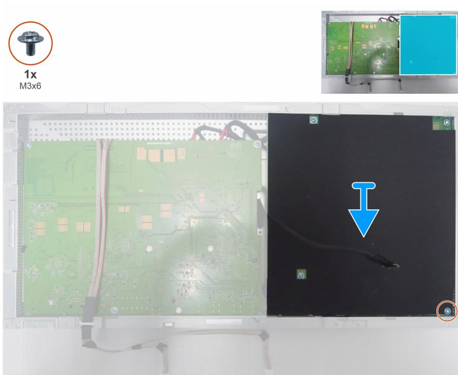
**Figura 12. Rimozione del foglio mylar**
