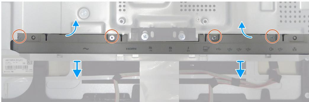
**Figura 5.** Retire la cubierta de E/S
