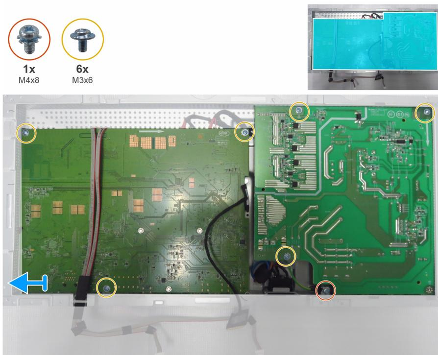
**Figura 13. Retire la placa principal y la placa de alimentación.**
