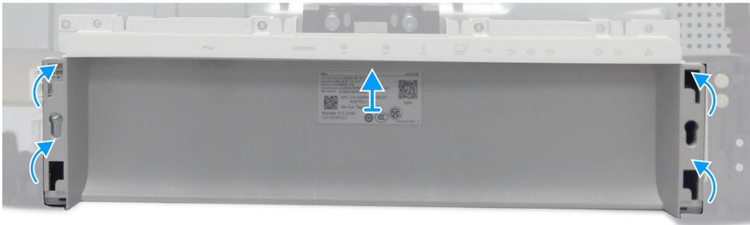
**Figura 4.** Retire la cubierta inferior trasera
