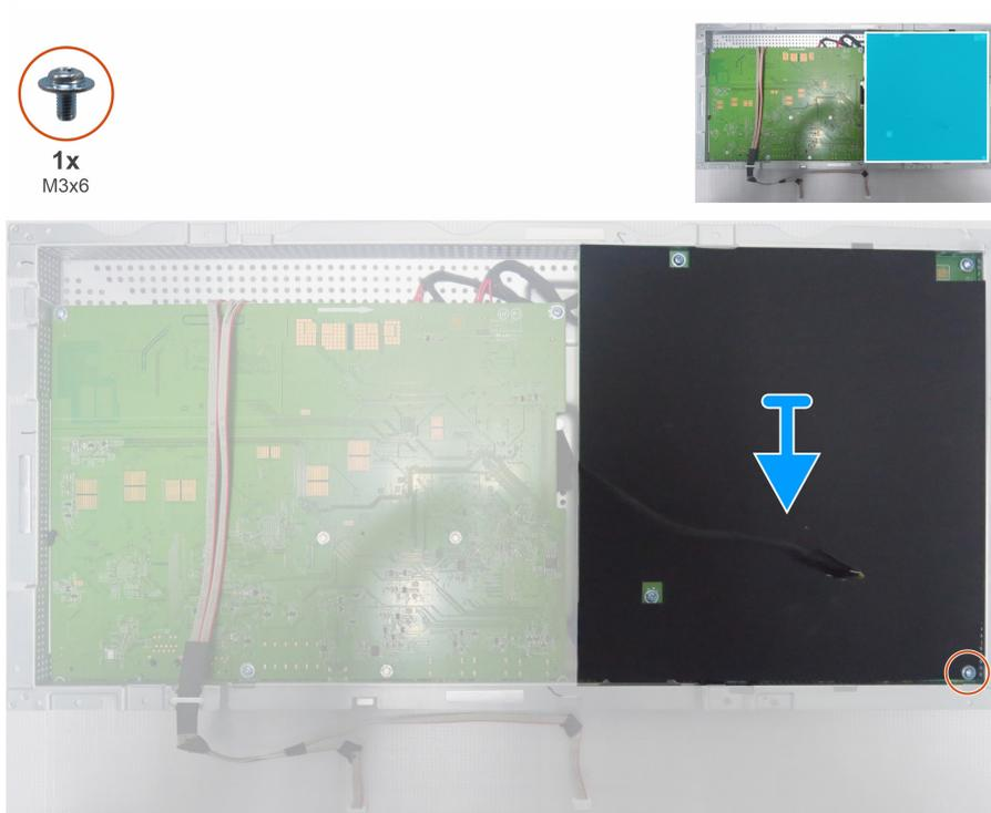
**Figura 12. Retire la lámina de Mylar**
