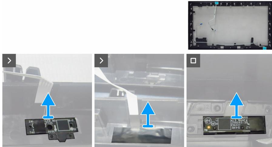
**Figura 11. Retire la placa LED y la placa ALS**
