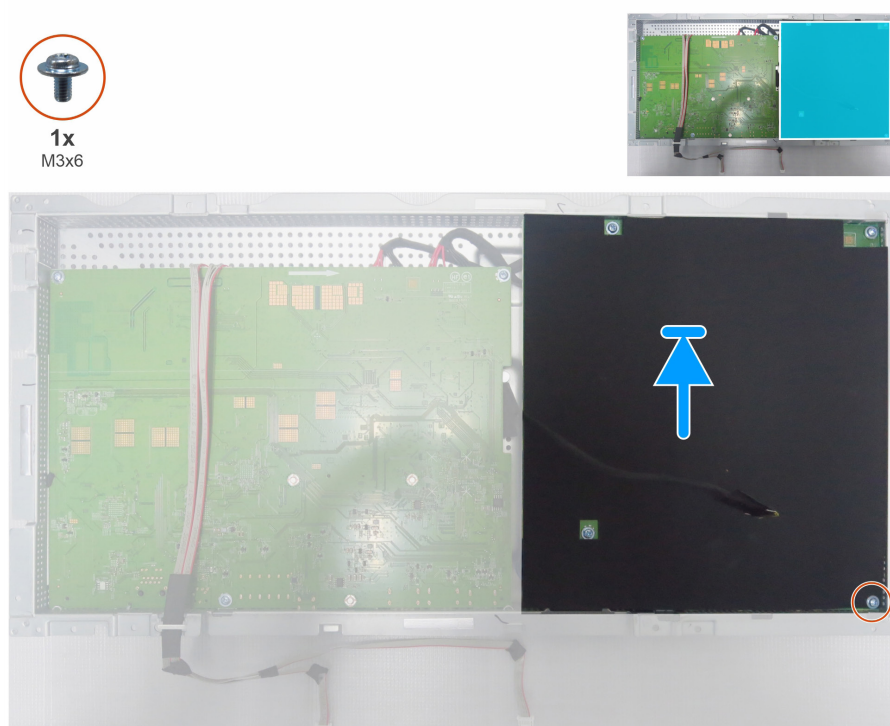
Figura 47. Instale la lámina de Mylar
