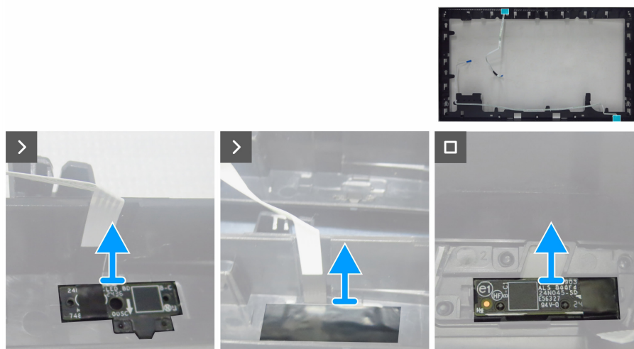
Figura 37. Retire la placa LED y la placa ALS
