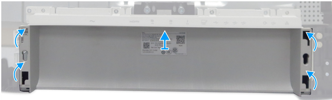
Figura 25. Retire la cubierta inferior trasera
