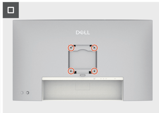
Figura 22. Instale la cubierta superior trasera
