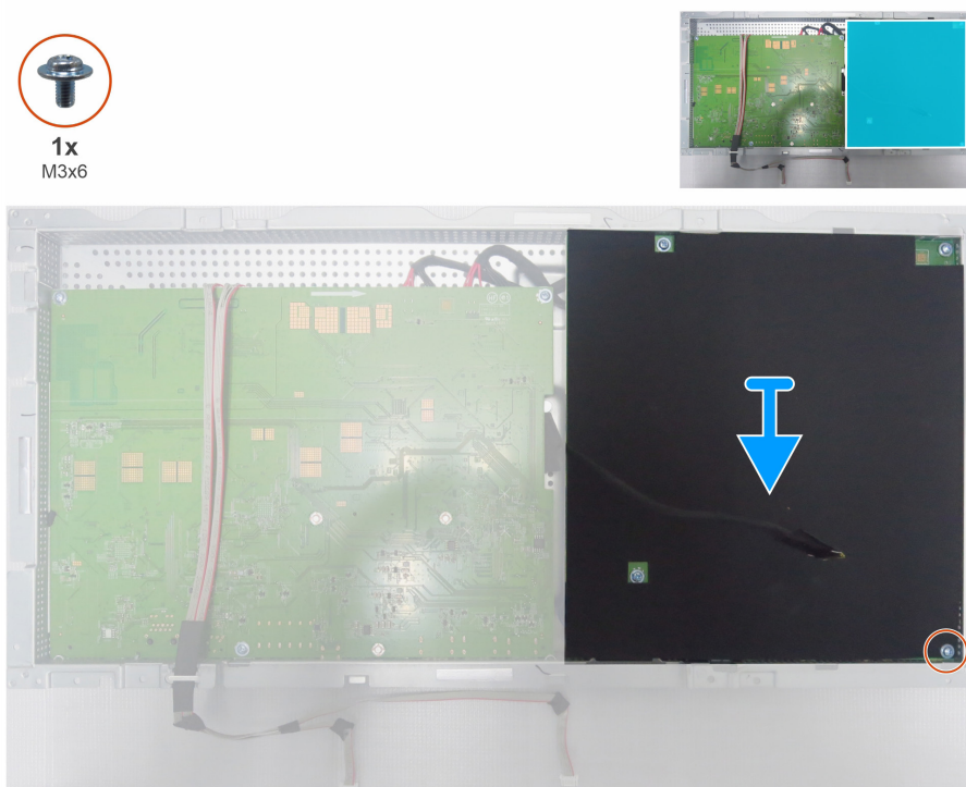
Figura 40. Retire la lámina de Mylar
