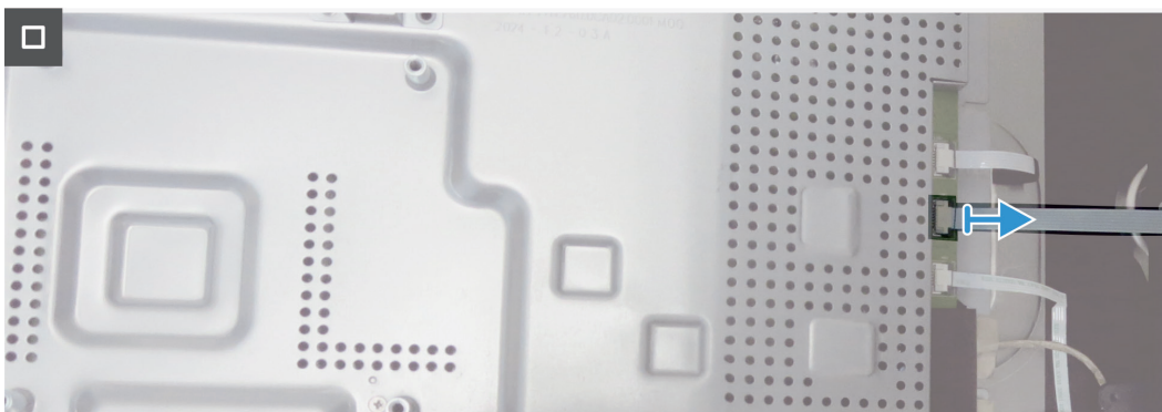
Figura 21. Retire la cubierta superior trasera
