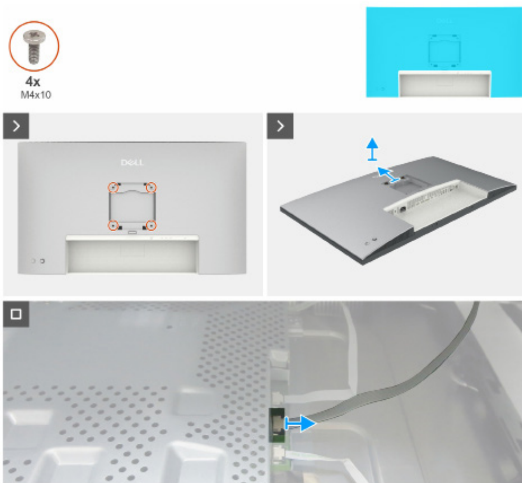
Figure 2. Enlever le couvercle arrière supérieur
