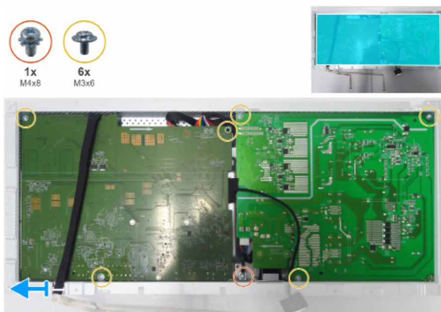
Figura 13. Remover a placa principal e a placa de alimentação
