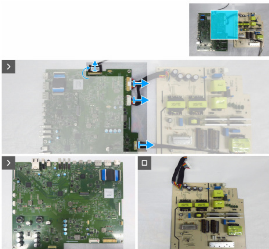
Figura 15. Desligar os cabos da placa principal
