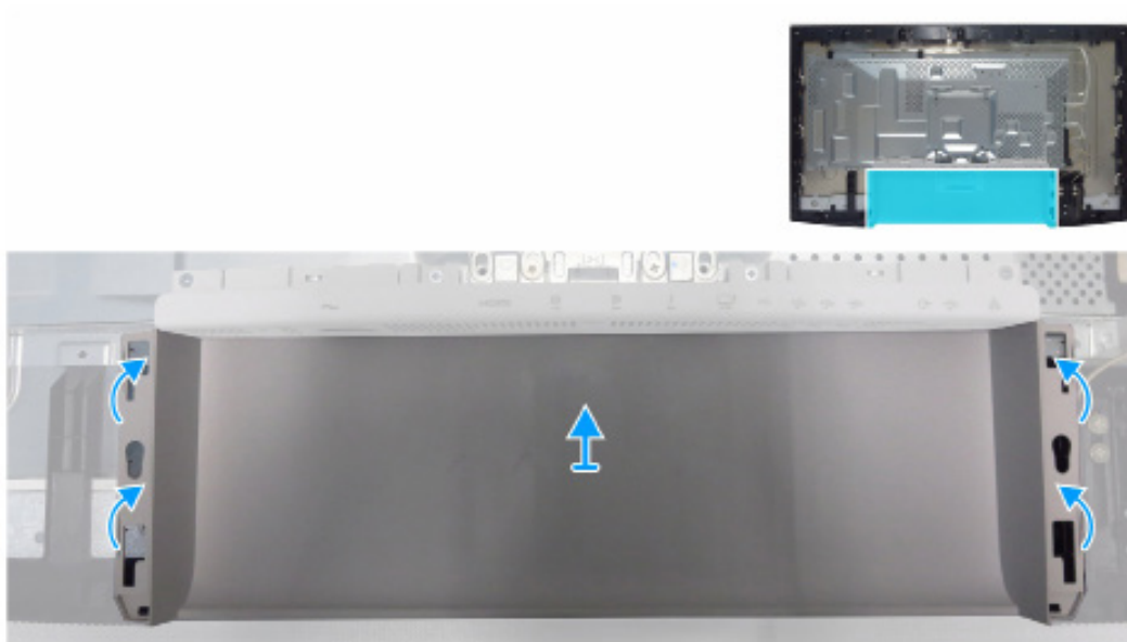
Figura 4. Remover a tampa traseira inferior
