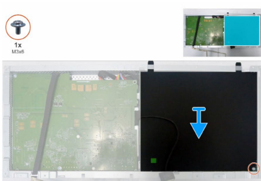
Obrázek 12. Odstranění mylarové fólie
