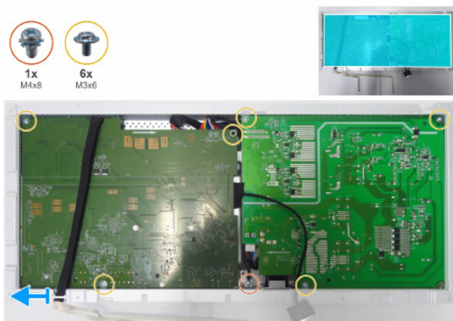
Obrázek 13. Demontáž hlavní desky a napájecí desky
