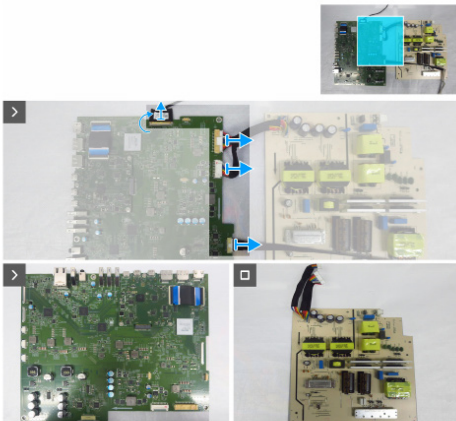
Obrázek 15. odpojení kabelů od základní desky
