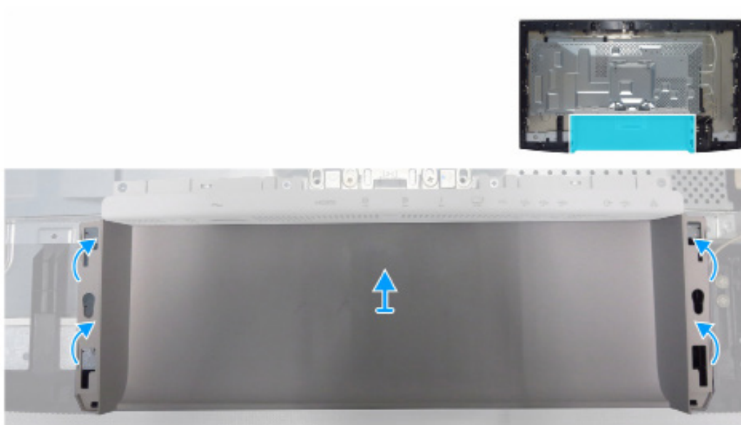
Obrázek 4. Demontáž spodního zadního krytu
